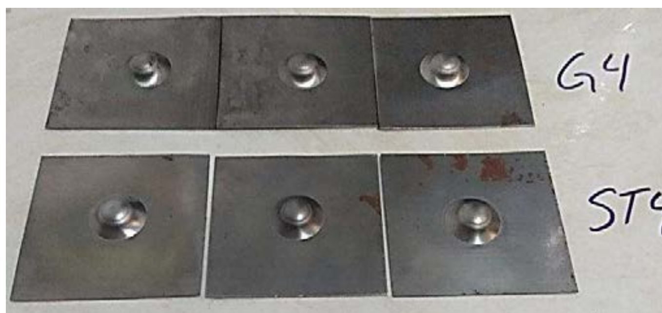
Figura 6: Chapas dos materiais G4 e ST4 após ensaio Erichsen
