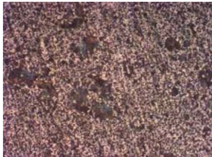
Figura 5: DIN38MnSV6 com resfriamento controlado, aumento de 100X, ataque de nital 4%.
