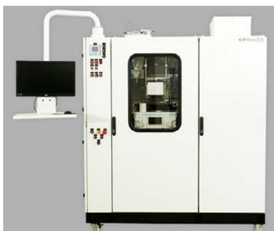
Figure 3: Equipamento OminiSint-160 de fusão seletiva a laser da empresa Ominitek.
