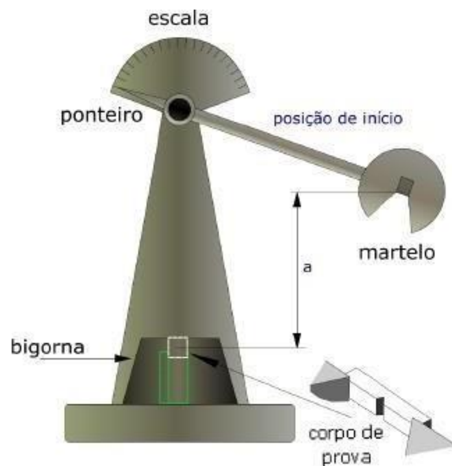
Figura 4 – Representação da máquina de ensaios charpy [4].
