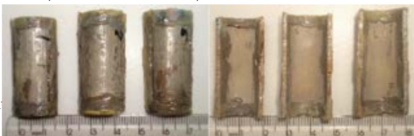
Figura 8: Aspecto visual do CP AC3 após o ensaio de imersão em cloreto férrico.
