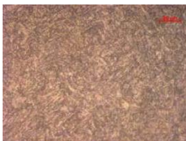
Figura 4: Análise metalográfica, com ataque de nital 4% e aumento de 500X.
