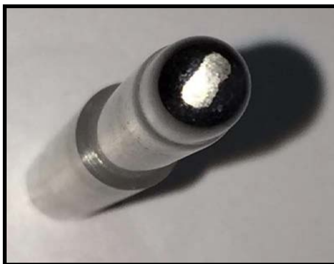
Figura 7 – Teste 2: Desgaste no polimento
