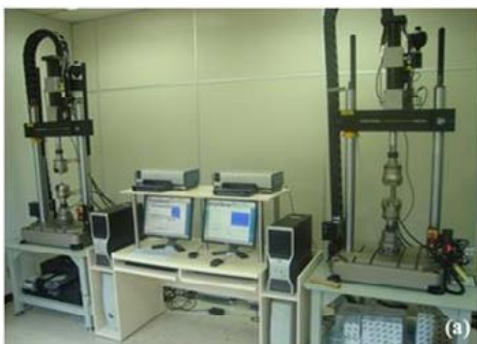
Figura 2: (a) Equipamentos e (b) dimensões dos corpos de prova utilizados para a realização dos ensaios de fadiga controlados por deformação, fabricados segundo a norma ISO 12106.
