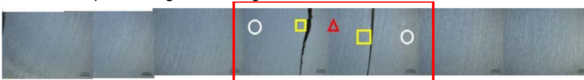
Figura 2: Imagem Estereomicroscópio soldagem condição 1. ● ZAT- ◻ ZATM- ▲ Stir Zone.
