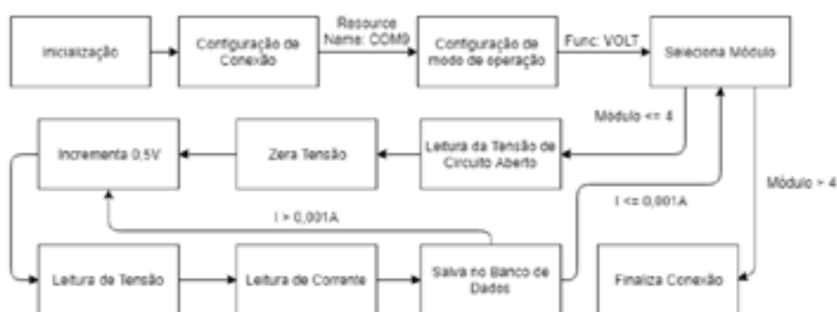
Figure 3: Processo de geração da curva I-V
