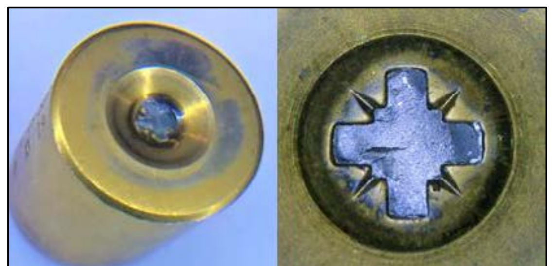
Figura 10: Fratura do punção Philips® em detalhe.
