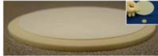
Amostra de beta alumina de 64 cm 2 antes de adicionar os eletrodos para os testes de flexão e resistividade
