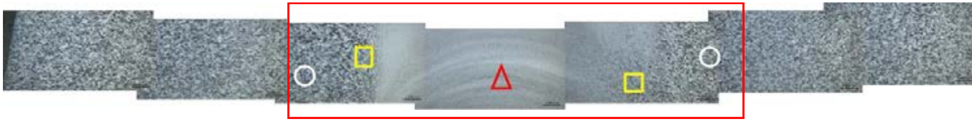
Figura 6: Imagem Estereomicroscópio soldagem condição 3. ● ZAT- □ZATM- ▲Stir Zone.
