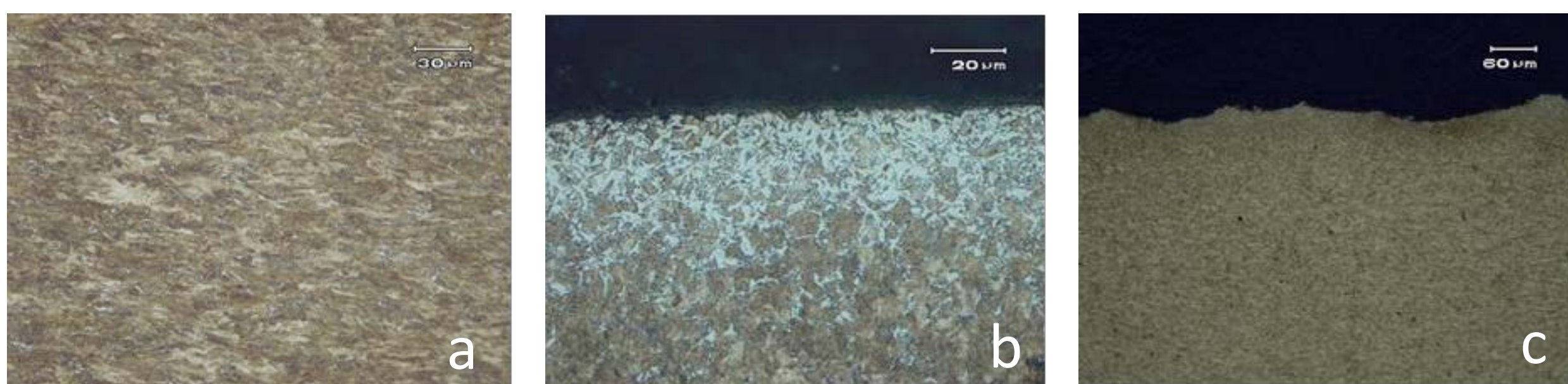
Figura 5 – a) Microestrutura – aumento 500x – reagente nital 2% b) Microestrutura do material com superfície descarbonetada. Aumento 1000x c) Superfície após o jateamento. Reagente nital 2%. Aumento 200x
