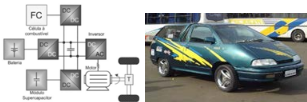
Figura 6 Veículo elétrico híbrido do projeto VEJA e o esquema elétrico do sistema
