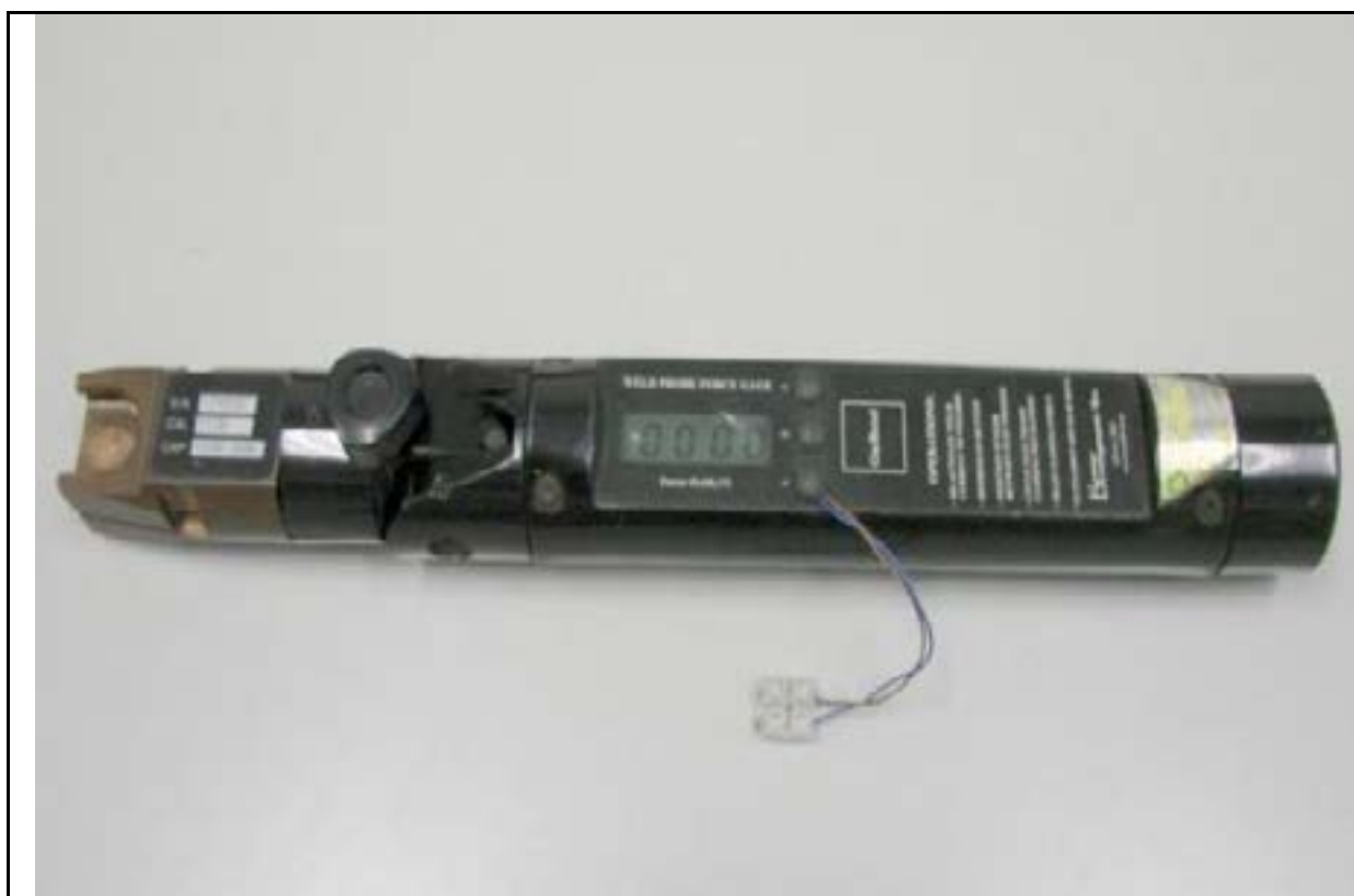
Figura 10 – Dinamômetro da marca Adis, utilizado para calibrar a força entre os eletrodos
