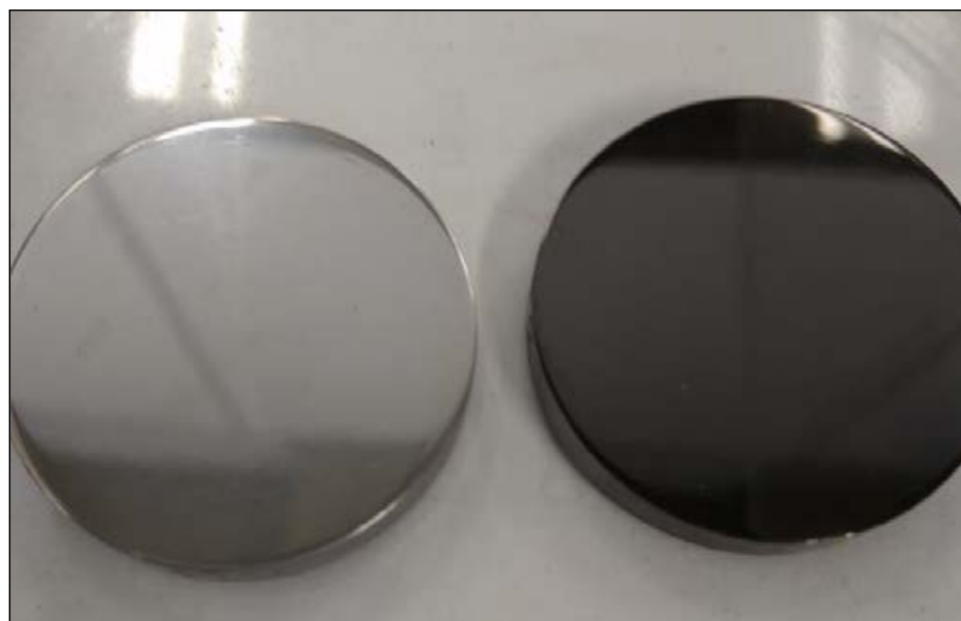
Figura 2: Corpos-de-prova da análise tribológica comparativa: a esquerda, o aço rápido VWM2; e a direita, o DLC depositado sobre o aço substrato.
