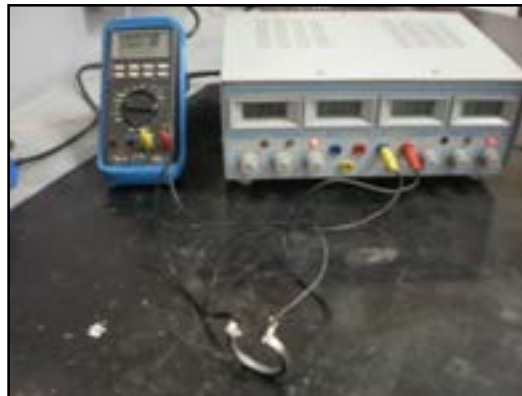
Figura 12 – Anel cortado com Terminais soldados e conectados a fonte elétrica e multímetro para determinação da Resistividade
