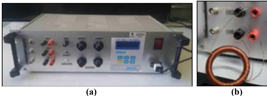
Figura 11 – Traçador de Curvas Magnéticas – (a) Modelo TLMP-TCH-14 – (b) Conectado ao anel bobinado
