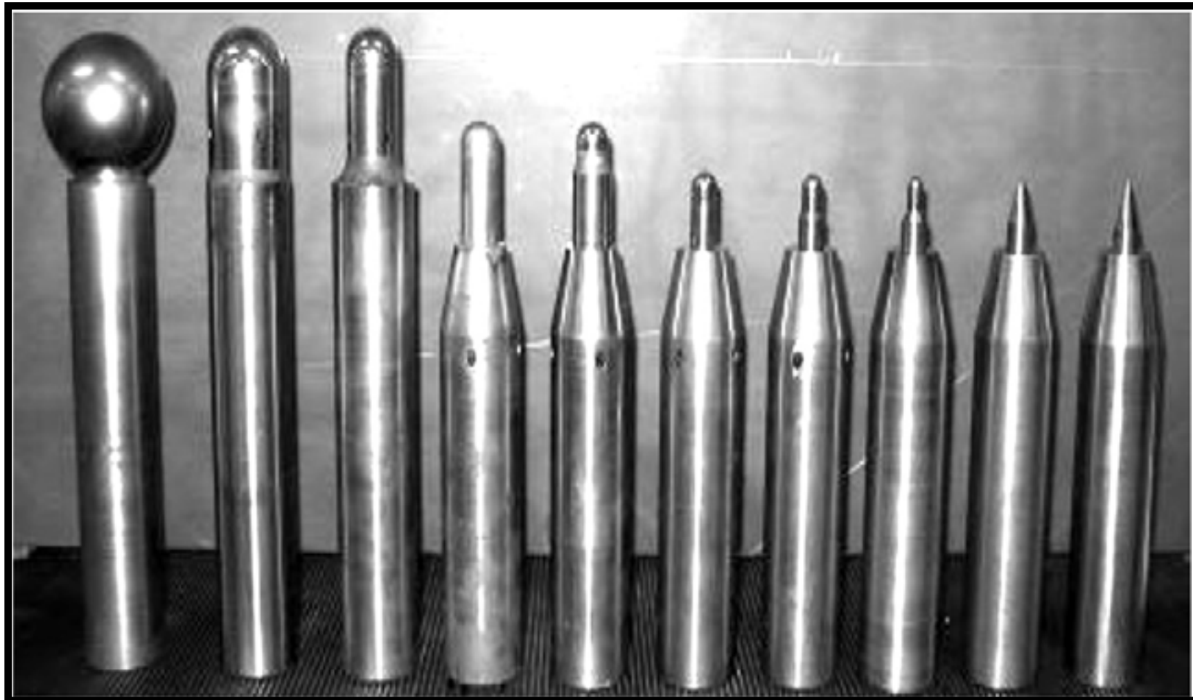
Figura 8 - Ferramentas Semi esféricas com variados diâmetros e formas
