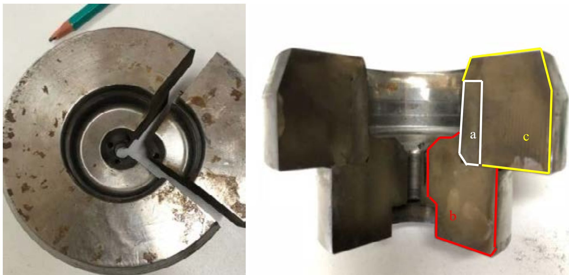
Figura 12 – Corte transversal del conjunto aro-base
