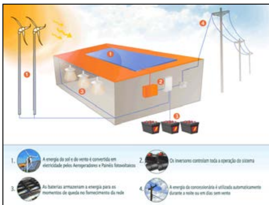
Figura 1 – Esquema de um Sistema Híbrido para Geração de Energia [1]
