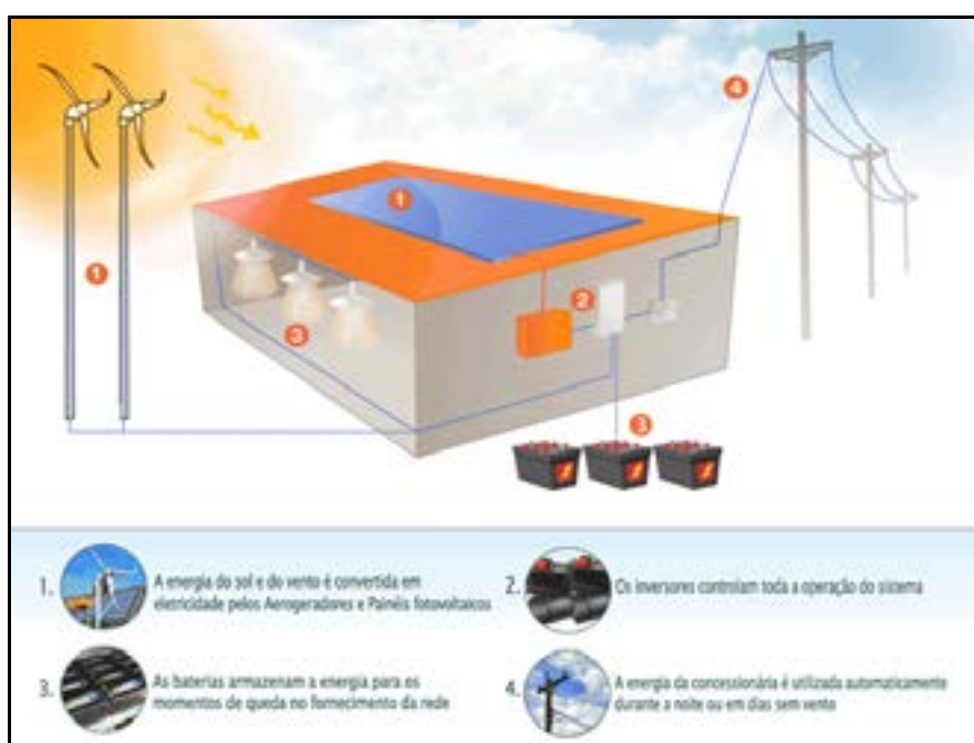
Figura 11 – Esquema de um Sistema Híbrido para Geração de Energia
