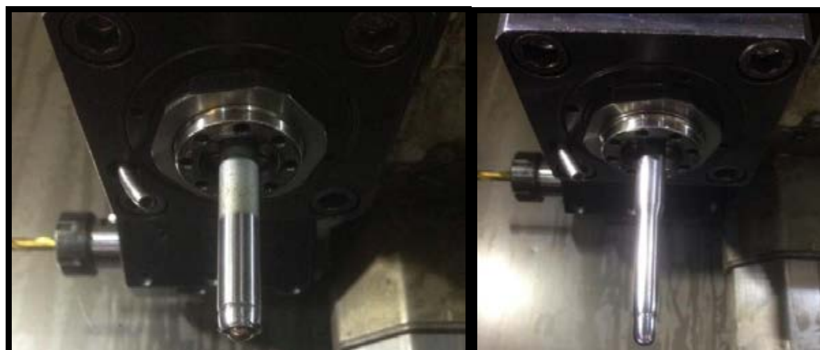
Figura 3 – Ferramenta de hidroconformação incremental com ponta roletada e semi-esférica.
