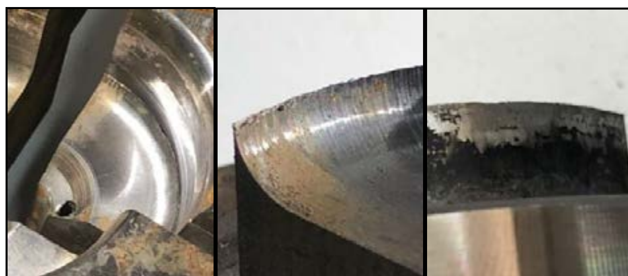
Figura 13 – Corte transversal del conjunto aro-base
