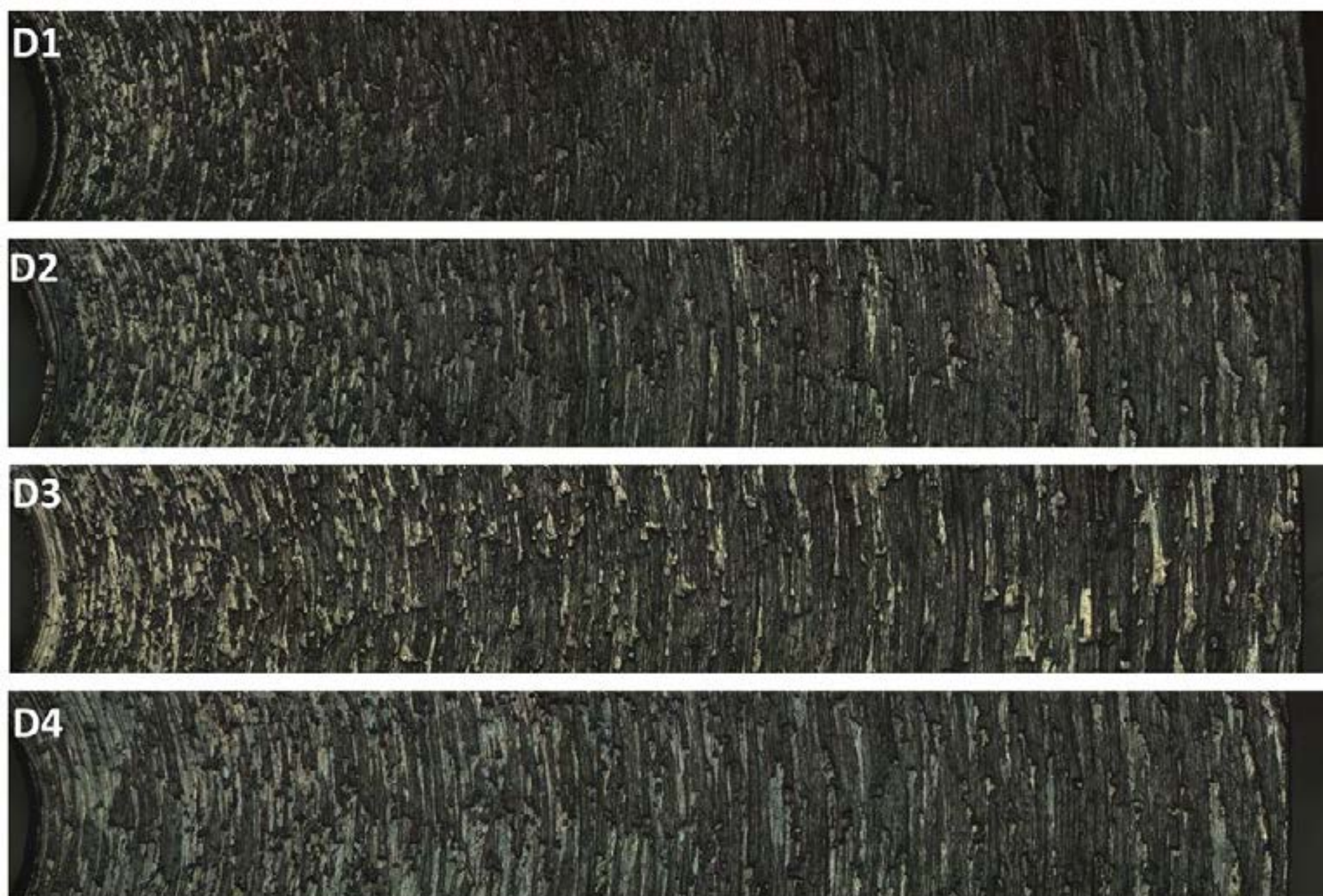
Figura 4: Caracterização superficial de amostras D1 à D4 do tipo disco, oriundas do processo de corte durante o torneamento, ampliados 25X.
