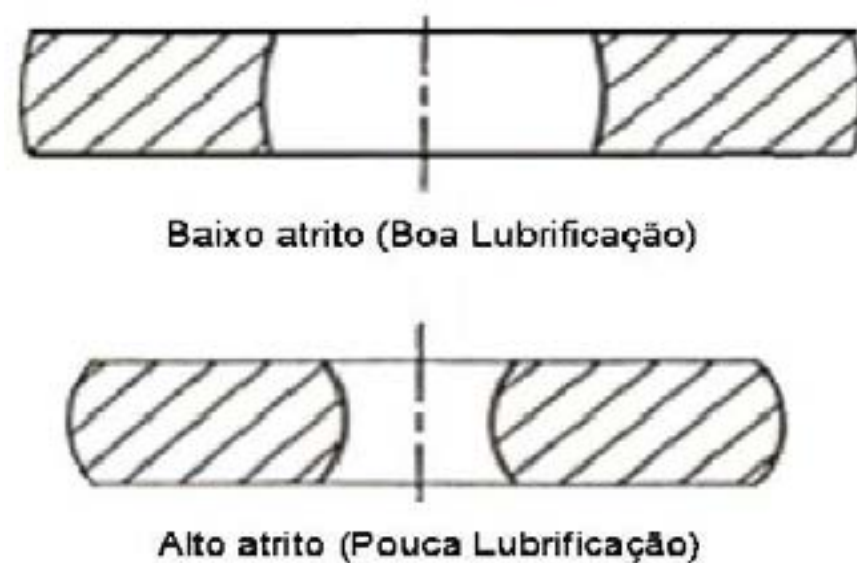
Figura 2: Efeito do atrito no fluxo do metal durante o teste de compressão do anel, V. Martins e L. Schaeffer (2009).
