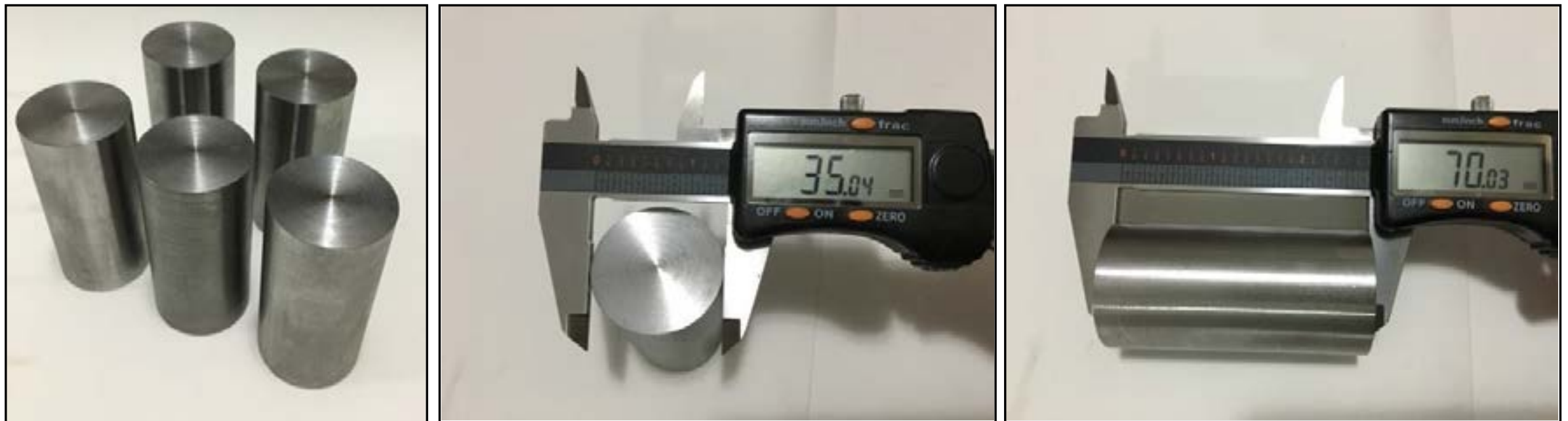
Figura 1: Corpos de prova de aço SAE1045 nas dimensões de 70mm x 35mm
