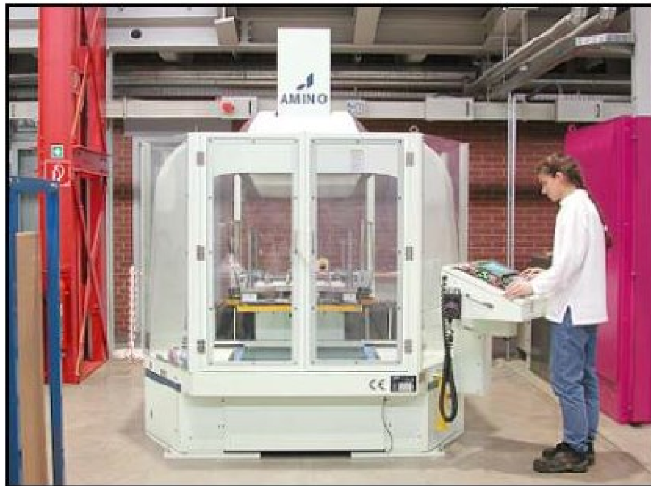
Figura 6 - Máquinas construída para a conformação incremental
