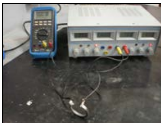
Figura 14 – Anel cortado com Terminais soldados e conectados a fonte elétrica e multímetro para determinação da Resistividade
