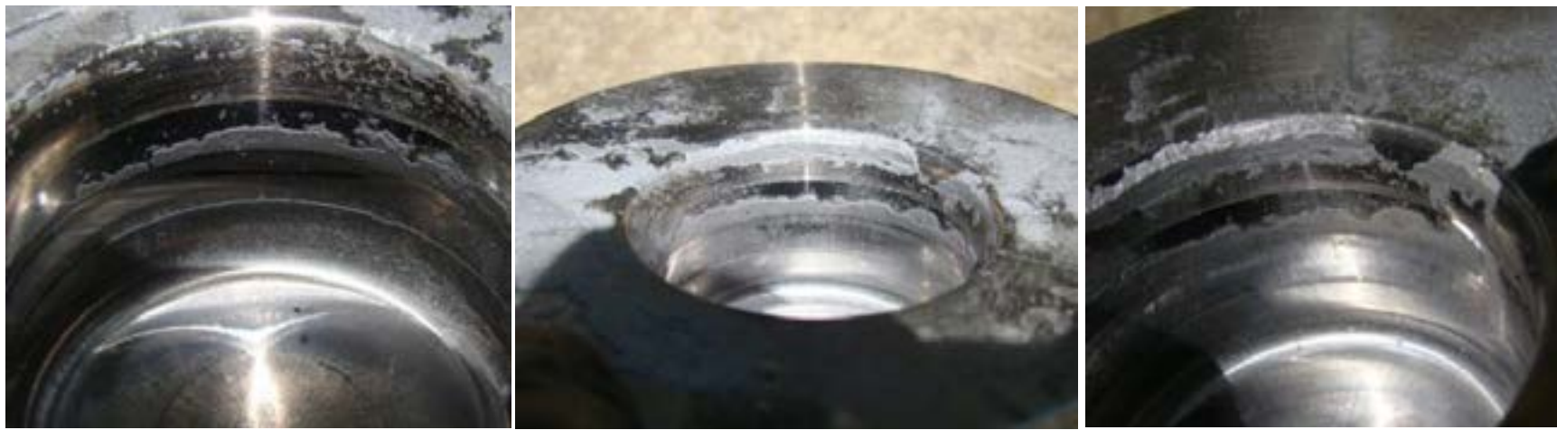
Figura 11 – Combinación de polvo y lubricante en el interior de la matriz
