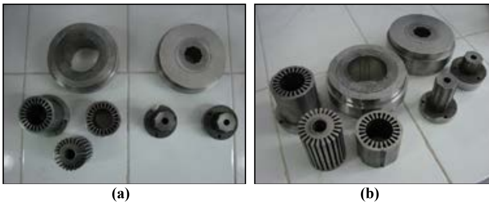
Figura 5 – Matrizes para compactação do servomotor – (a) Rotor – (b) Estator
