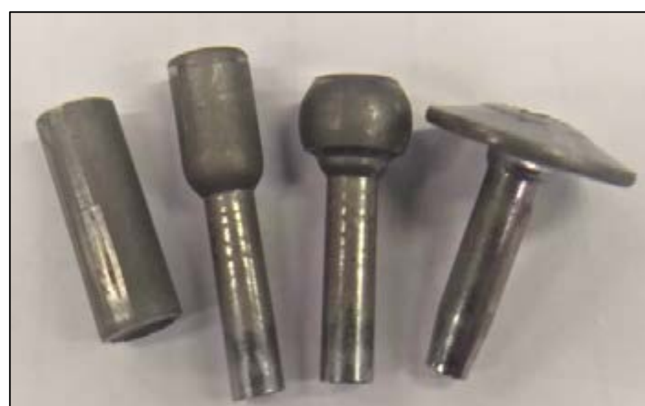
Figura 3: Resultado do tryout físico da Sequência de Conformação Original (SCO).
