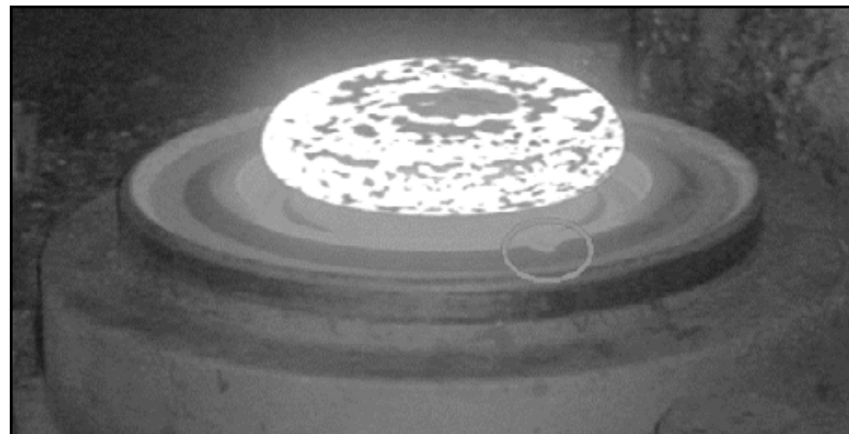
Figura 13 - Primeira operação de forjamento, pré-forma.
