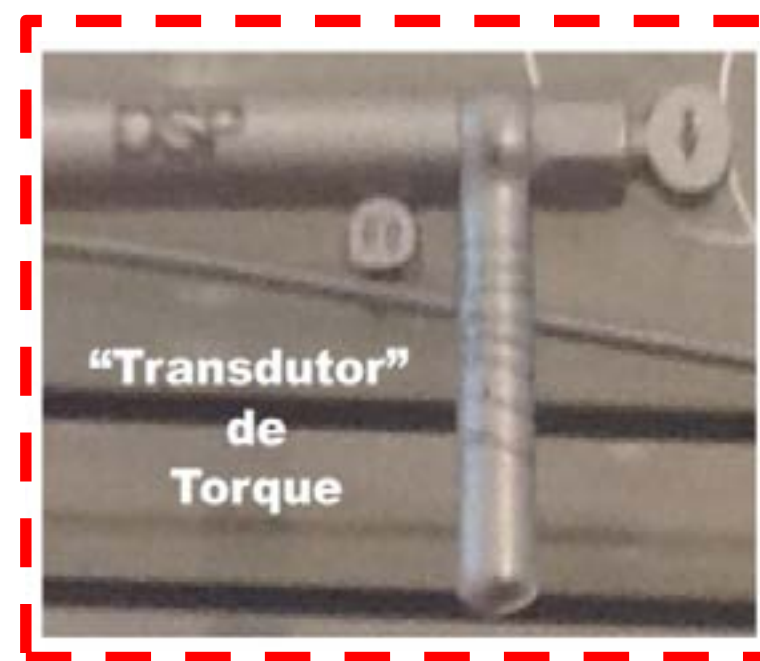
Figura 17 B.- Detalhe do "transdutor de Torque", onde o profissional da área de Odontologia busca 32 Ncm, pois o exemplo se refere a um Parafuso M1,2.
