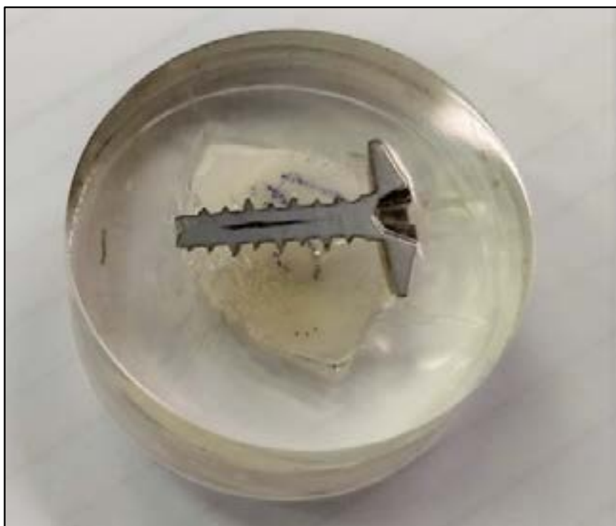
Figura 4: Descontinuidade interna identificado em algumas peças do lote produzido (1º problema).
