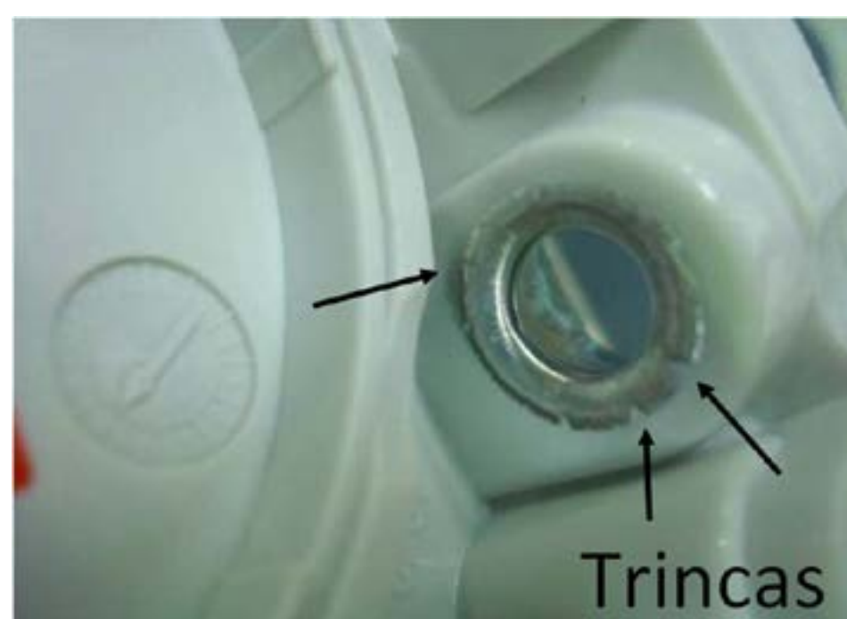
Figura 2: Trincas após remanche da bucha na carcaça
