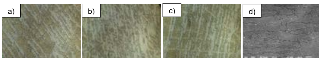
Figura 3: (a) Amostra A, (b) Amostra B, (c) Amostra C e (d) Análise da microestrutura do aço inoxidável superduplex realizado no MEV.
