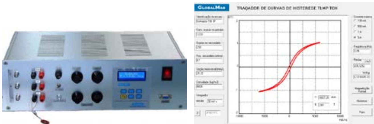
Figura 8 – (a) Equipamento para de medição da curva de histerese e (b) software de aquisição [20].
