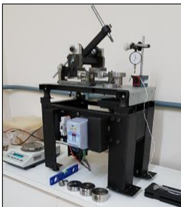
Figura 1: Dispositivo para ensaios tribológicos do tipo pino-sobre-disco [1].
