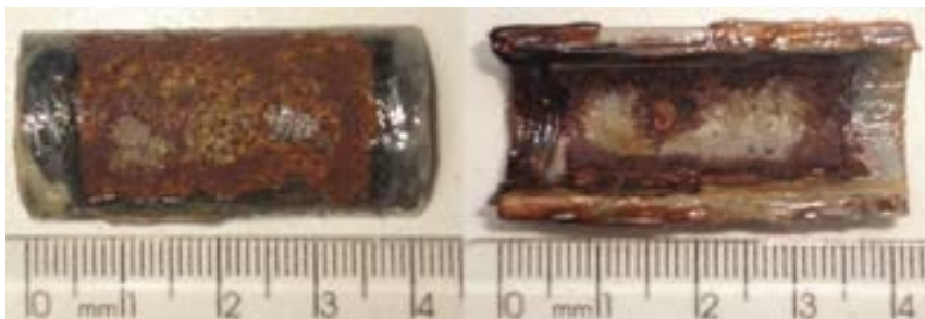
Figura 8: Aspecto visual do CP AC3 após o ensaio de imersão em cloreto férrico.
