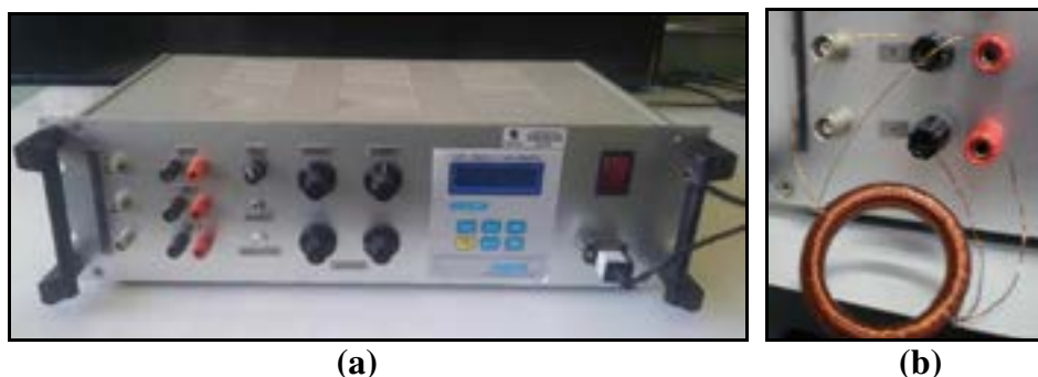
Figura 12 – Traçador de Curvas Magnéticas – (a) Modelo TLMP-TCH-14 – (b) Conectado ao anel bobinado
