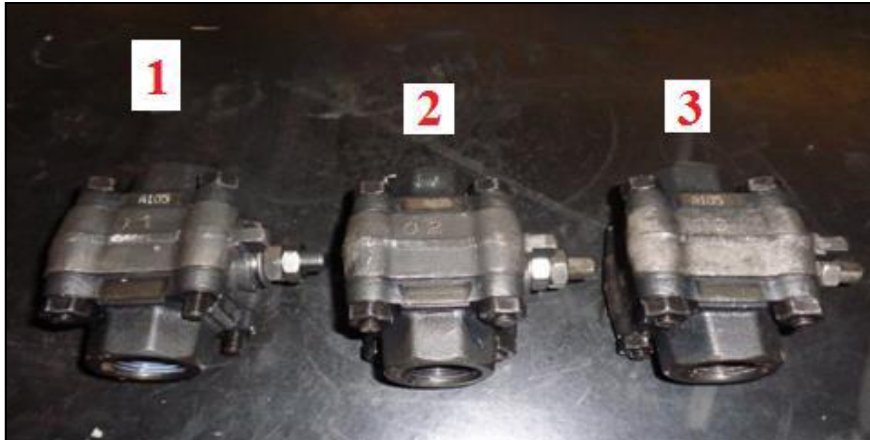
Figura 4: Protótipos de Válvulas montados com as esferas nitretadas.
