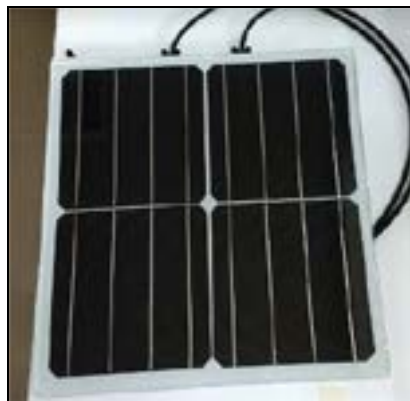
Figura 3: Módulo fotovoltaico após o processo de laminação (Fonte: do autor).
