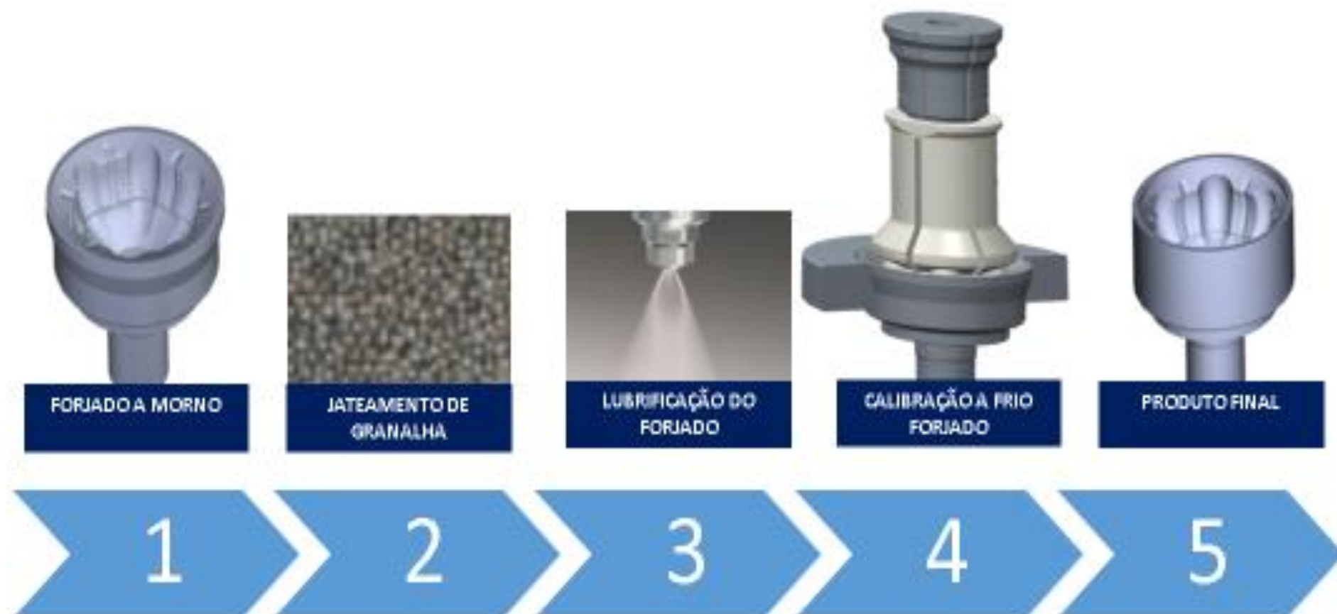
Figura 1: Fluxograma do processo de calibração a frio.
