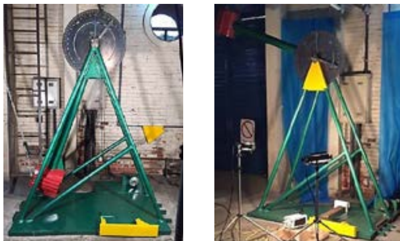
Figura 5: (a) Equipamento do ensaio de impacto desenvolvido; (b) Posicionamento da câmera de alta velocidade.
