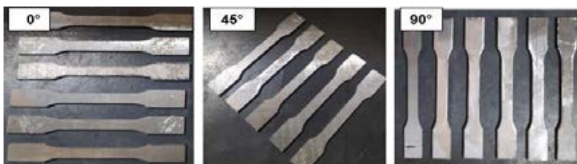
Figura 5: Corpos de prova para ensaio mecânico de tração. Do autor, (2021)
