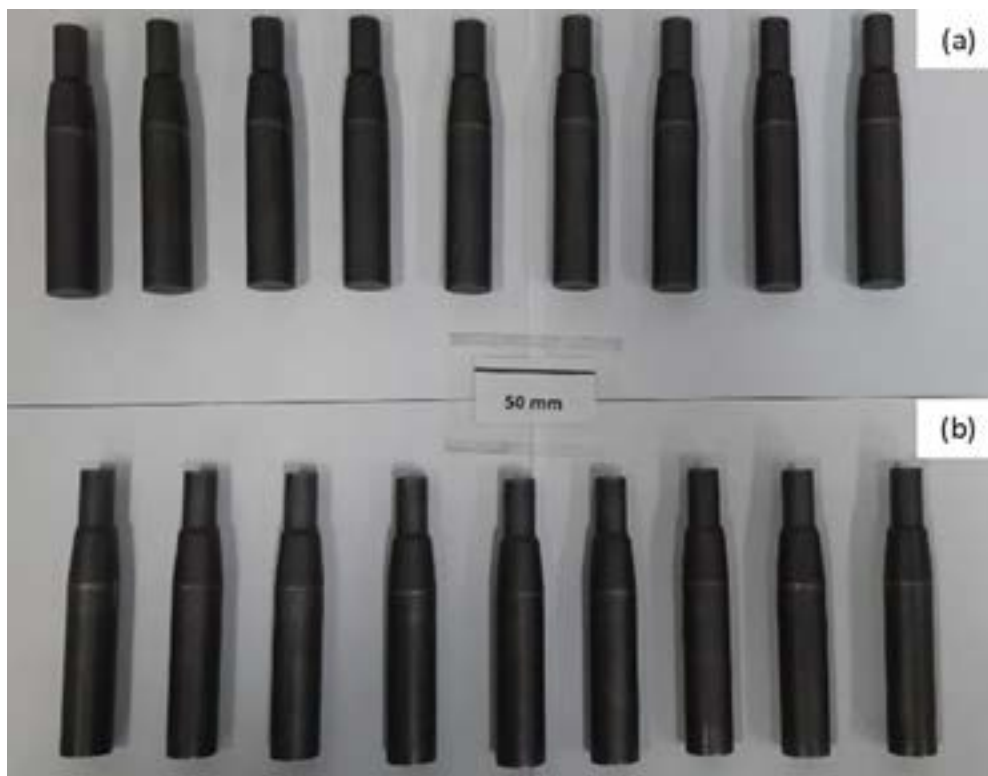
Figura 9 – Amostras forjadas a frio (a) sem e (b) com tratamento térmico.
