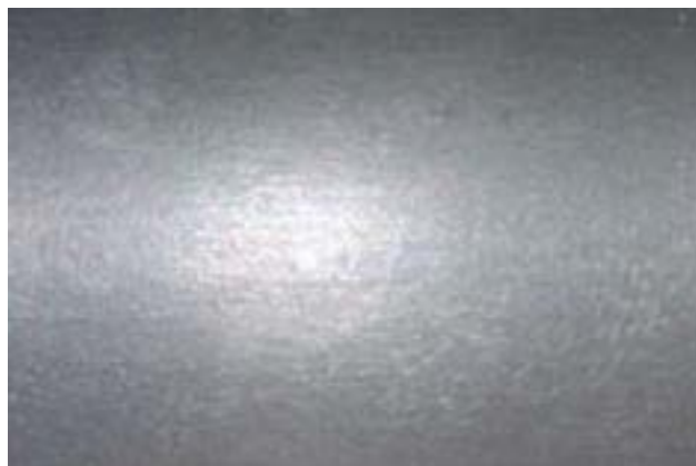
Figura 14 - Superfície Corpo de Prova Conformado a Quente
