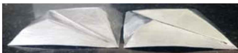
Figura 14: Retorno elástico presente nos experimentos ISF.
