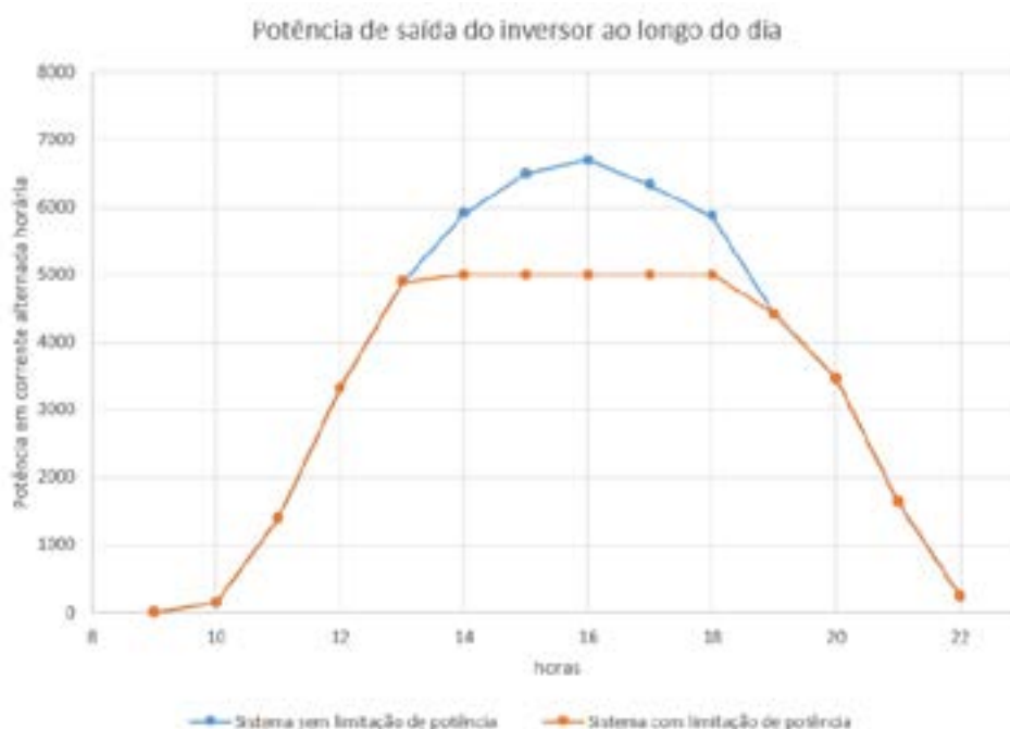
Figura 1 – Comparação do comportamento para sistemas com e sem limitação de potência devido ao carregamento do inversor em um dia de alto índice de irradiação.
