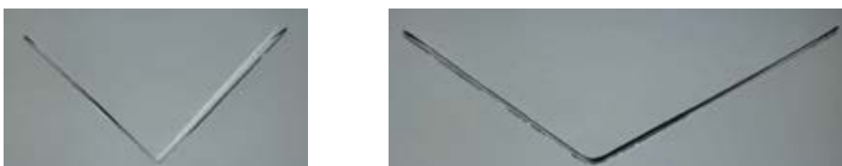
Figura 3 – a – Dobra com ferramenta de raio 1,0 mm; b - Dobra com ferramenta de raio 5,5 mm
