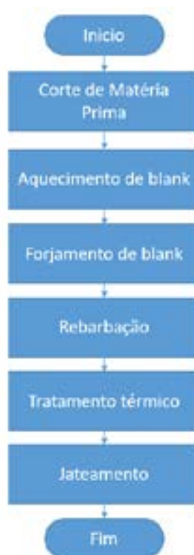
Figura 2: Fluxo produtivo de um processo de forjamento a quente.
