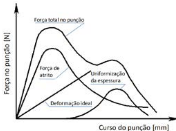
Figura 1: Representação do comportamento da força durante os processos de estampagem [5]
