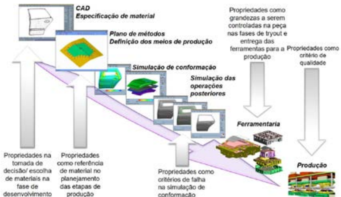
Figura 1: Diferentes funções das propriedades mecânicas das chapas durante as etapas do desenvolvimento de um componente estampado. Fonte: IFU Stuttgart.
