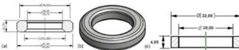
Figura 1: Representação da arruela forjada a quente, (a) mostrada em corte; (b) representação 3D e (c) Corpo de prova usinado para ensaio de compressão.
