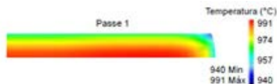
Figura 1: Exemplo de resposta em do campo de temperaturas em [°C] dada pelo software de elementos finitos após uma análise de deformação de uma chapa laminada. Retirado de [5].
