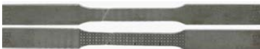
Figura 5: Imagen de las fracturas durante ensayo de tracción JFE - CA 1180 marcada y sin marcar
