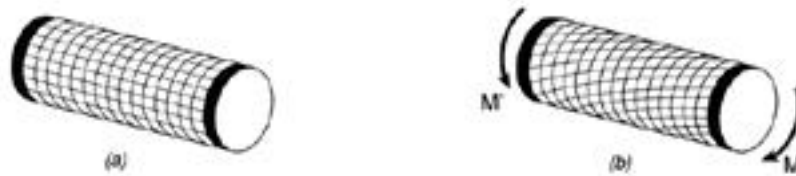
Figura 2 - Região útil de uma amostra submetida a um esforço de torção. (a) Antes da aplicação do esforço e (b) depois de aplicado o momento torçor.
