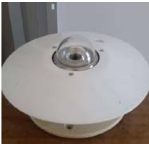
Figura 2: Piranômetro termoeletrico com dois hemisférios de cristal. Adaptado de [16]
