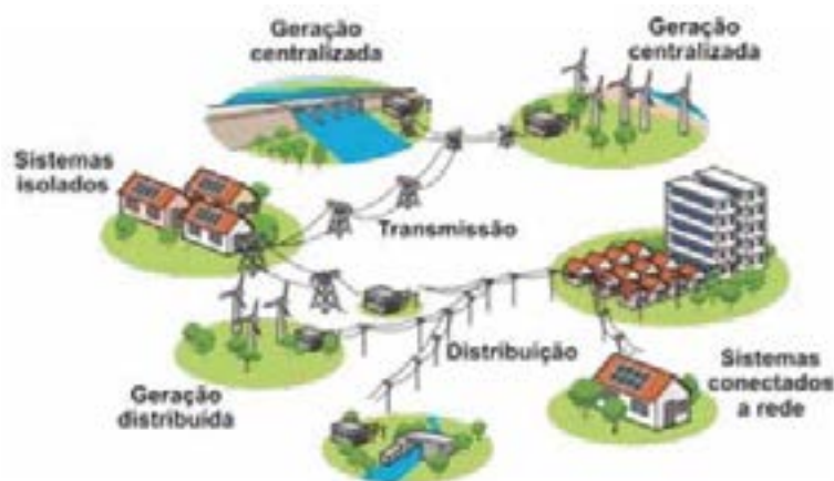
Figura 1: Diagrama simplificado de um sistema elétrico de potência [1].
