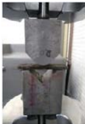
Figura 6 – Ferramental utilizado para o dobramento.
