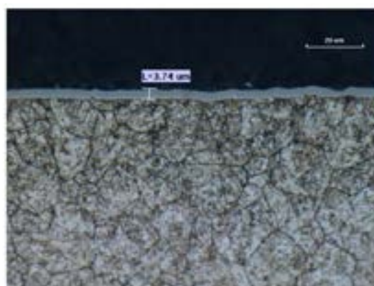
Figura 26: Espessura revestimento CrAlN, 1000x
