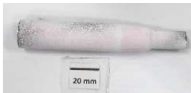
Figura 10 – Ensaio não destrutivo de líquido penetrante (amostra com tratamento térmico).
