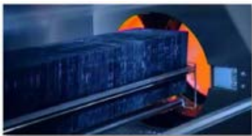
Figura 16 – Lâminas no forno de difusão de fósforo (P)
