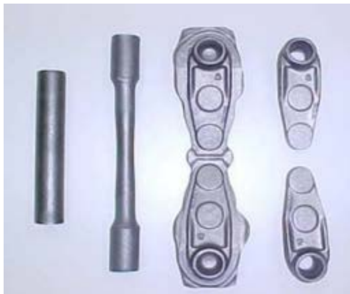
Figura 1 - Etapas do processo de forjamento [4]
