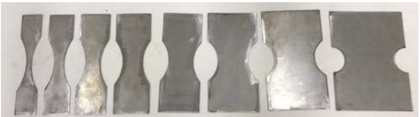
Figura 1 - Corpos de prova para ensaio de conformação - método Nakazima modificado.
