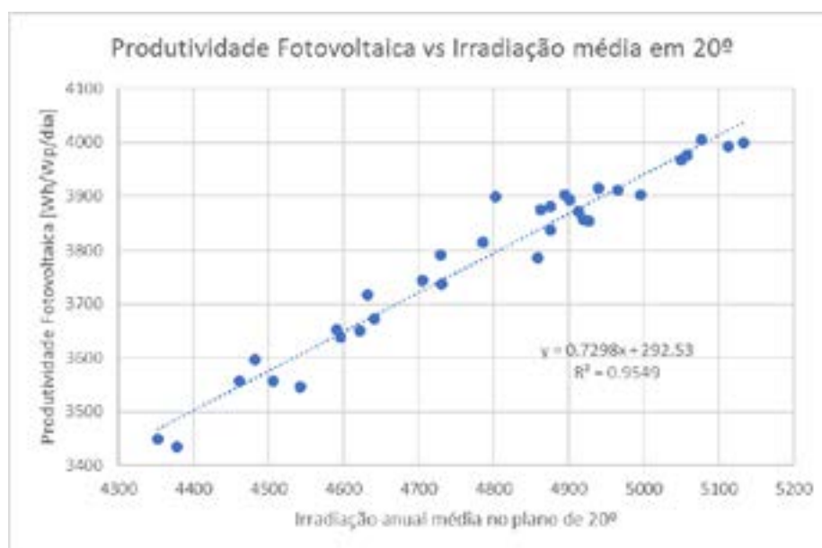
Figura 2 – Relação entre a produtividade fotovoltaica sem limitação de potência e a irradiação média anual no plano de 20°.
