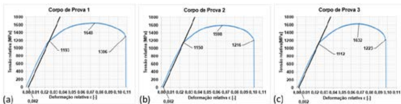
Figura 7 –(a) Tensão versus deformação relativa Corpo de prova 1; (b) Tensão versus deformação relativa Corpo de prova 2; (c) Tensão versus deformação relativa Corpo de prova 3.
