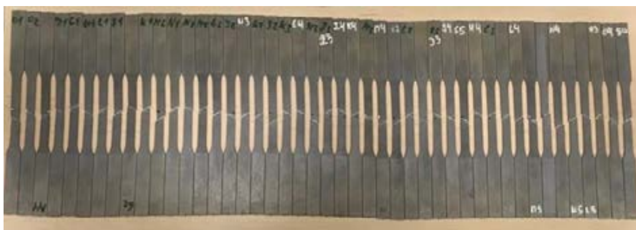
Figura 8: 45 probetas ensayadas de acero JFE - CA 1180 como resultado del DOE
