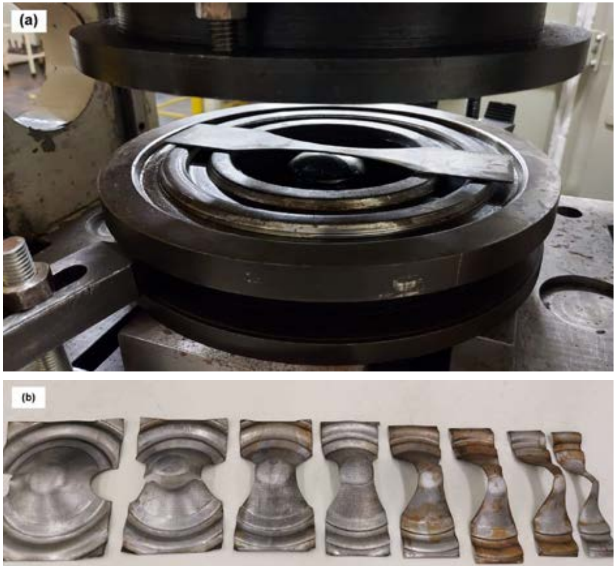
Figura 3 - (a) Prensa hidráulica com corpo de prova; (b) Corpos de prova após ensaio de conformação.
