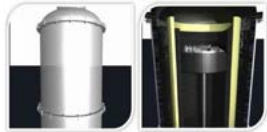
Figura 10 – Cadinho do método Czochralski
