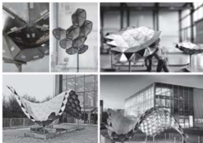
Figura 5: Montagem final da estrutura criada por chapas dobradas pelo processo de ISF [21].
