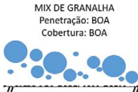
Figura 4: Poder de limpeza e cobertura de superfície de mix ideal de granalhas.
