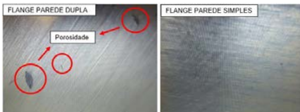
Figura 7: Porosidade entre união dos cordões. Do autor (2021).
