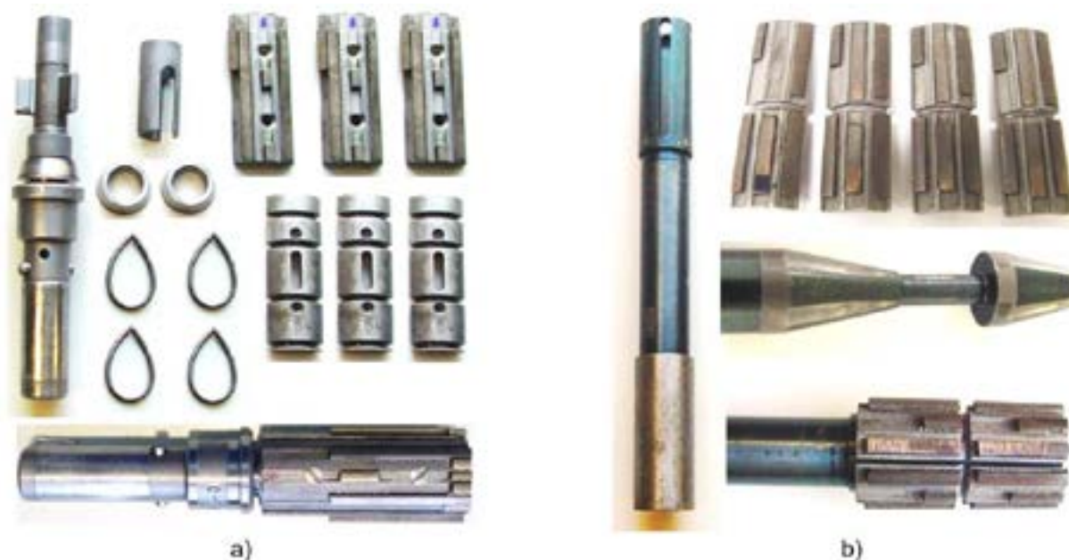
Figura 1: Ferramentas de brunimento para abrasivos de a) AlOx e b) CBN.
