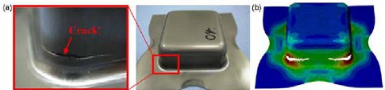
Figura 6. Comparação do experimento (a) e simulação (b).[4]
