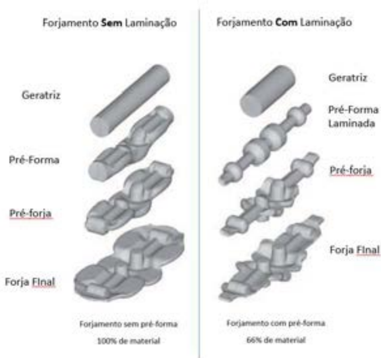
Figura 2 - Matéria prima aplicada sem e com pré-forma laminada [6]
