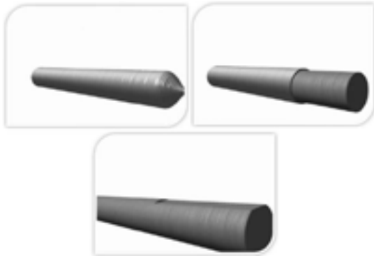
Figura 12 – Processo de corte das pontas e desbaste
