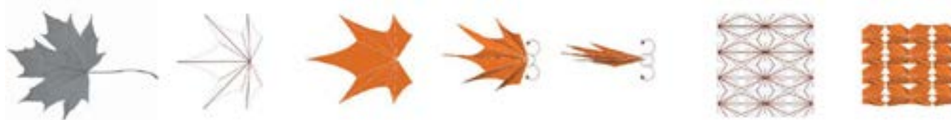
Figura 6: Montagem final da estrutura criada por chapas dobradas pelo processo de ISF [22].
