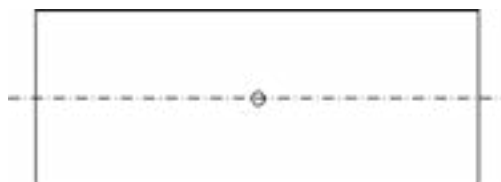
Figura 5 – Representação esquemática da seção longitudinal de um eixo de grande porte contendo um vazio interno.
