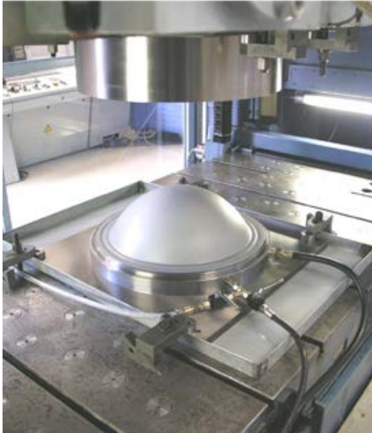
Figura 16: Foto de um ensaio de expansão Bulge montado (Fonte: IFU Stuttgart).
