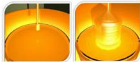
Figura 11 – Produção do lingote de silício monocristalino com método Czochralski.
