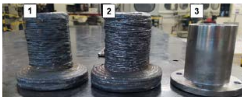
Figura 6: Flanges comerciais impressos por MA. Do autor (2021)
