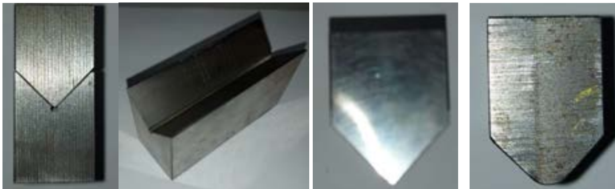
Figura 2 – a – Matriz e punção montados; b – Matriz; c – Punção com raio de 1,0mm; d – Punção com raio de 5,5mm.
