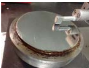
Figura 2.2 - Medição de rugosidade na orientação transversal em um disco após o processo de polimento.
