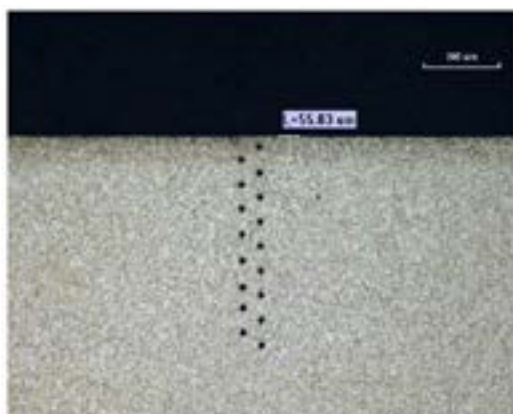
Figura 25: Zona difusão revestimento Dúplex CrAlN
