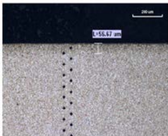
Figura 21: Zona difusão revestimento Dúplex TiAlN
