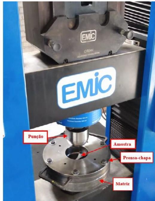
Figura 11 – Representação do ensaio Nakazima modificado executado na EMIC.
