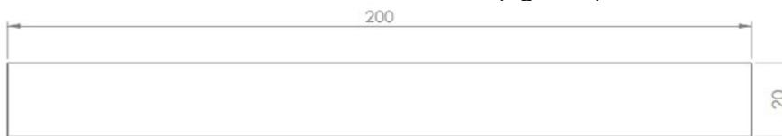
Figura 1 – Amostras utilizadas no ensaio de tração e de anisotropia.
