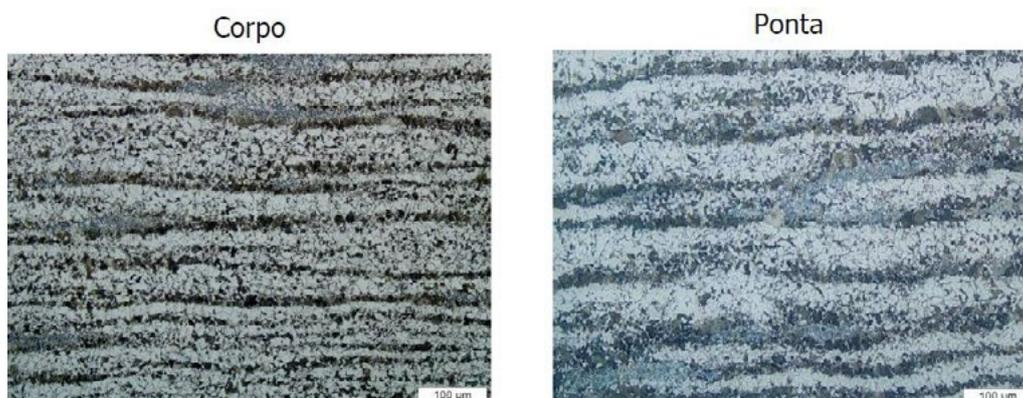
**Figura 6:** Microestrutura da região do corpo e ponta da viga com tratamento térmico – 200x.
