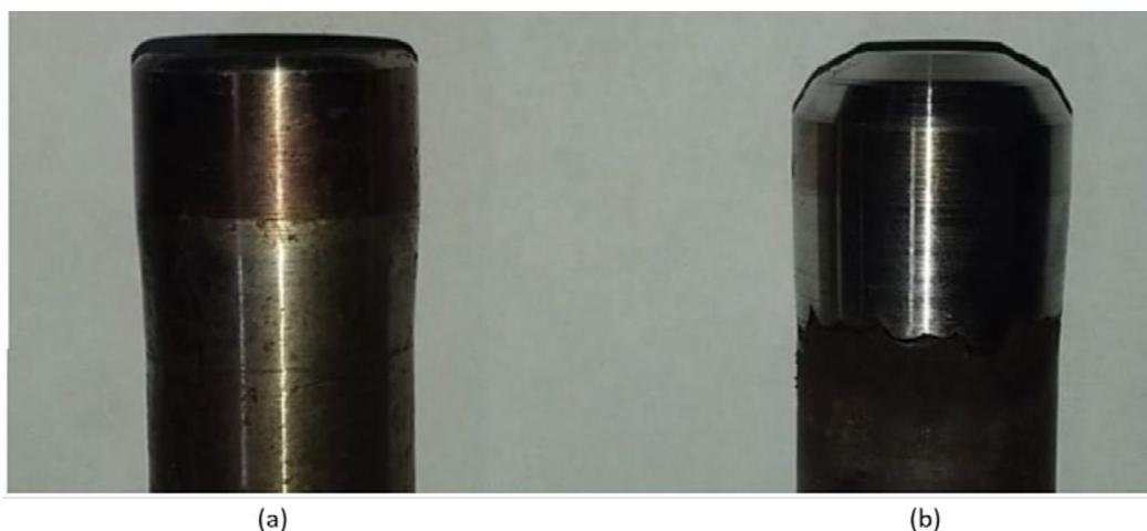
Figura 10 – Punção (a) antigo e (b) novo.
