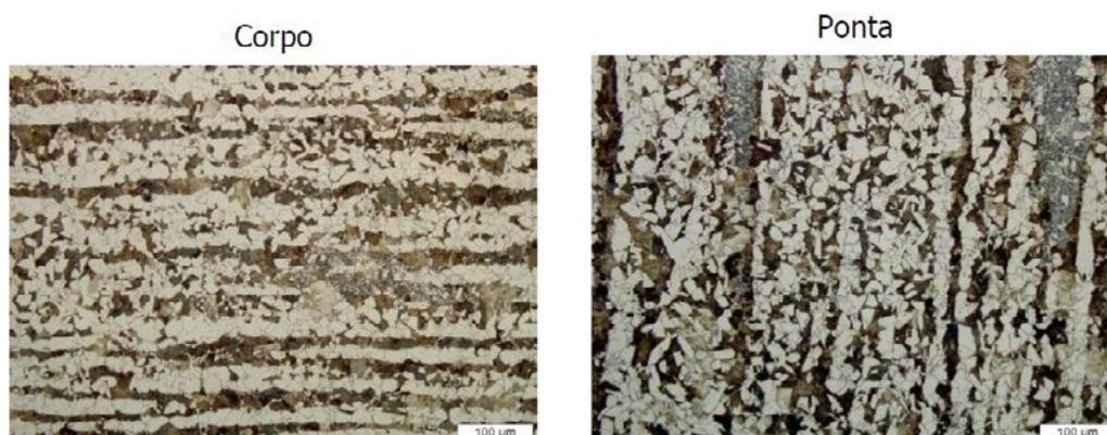
**Figura 7:** Microestrutura da região do corpo e ponta da viga sem tratamento térmico – 200x.
