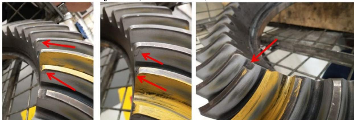
Figura 4 – Descontinuidades identificadas na Coroa forjada, tratada termicamente e usinada.
