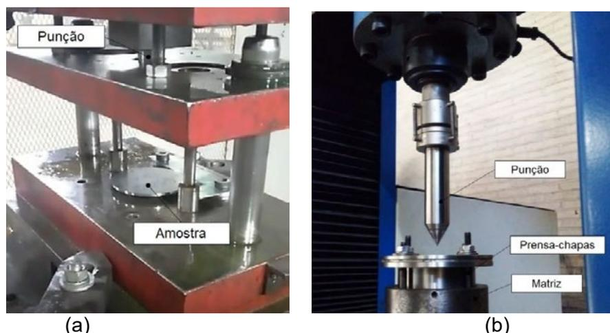
**Figura 2:** Processo de corte por punçionamento das amostras de expansão de furo.
