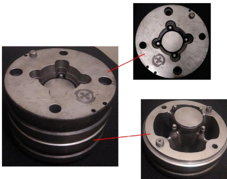
Figura 8 – Espina e matriz fabricadas para o processo de extrusão de um perfil tubular simétrico.
