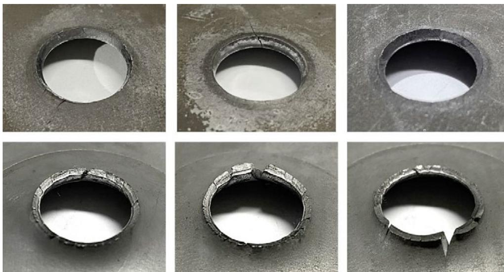
**Figura 8:** Corpos de prova após o ensaio de expansão de furo.
