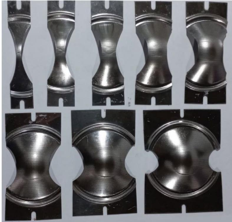
Figura 13 – Representação das amostras após o ensaio Nakazima modificado.
