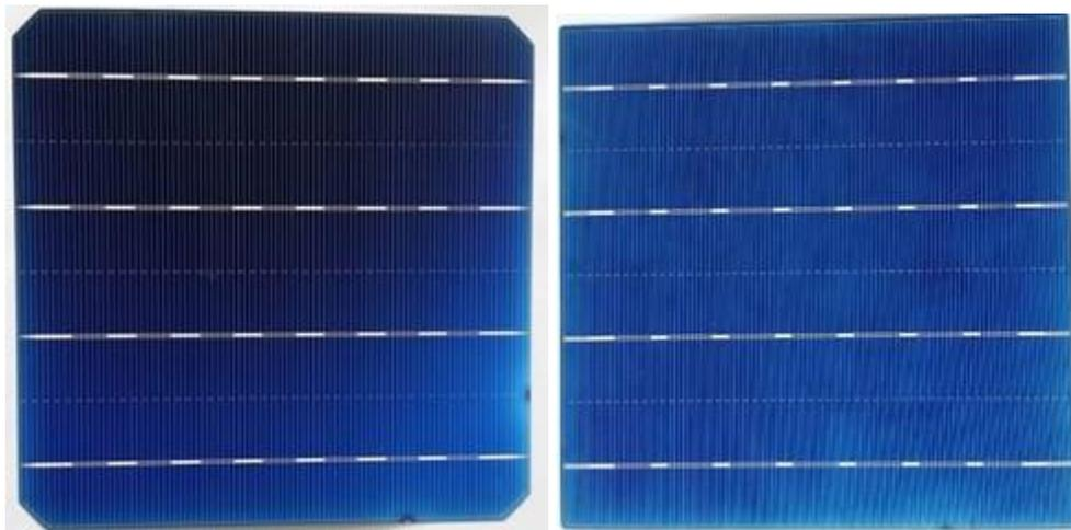
Figura 7 - Células de c-Si, (a) m-Si, (b) mc-Si (Rosso, 2019)
