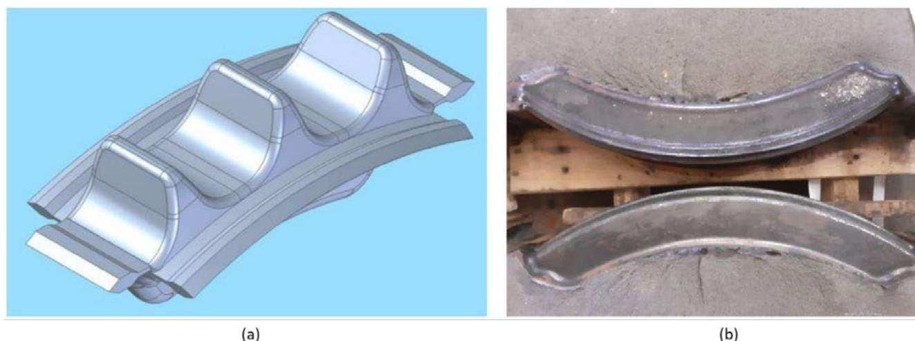
Figura 9 – (a) Produto projetado que causou a (a) quebra da matriz inferior (aspecto da fratura nas duas metades).
