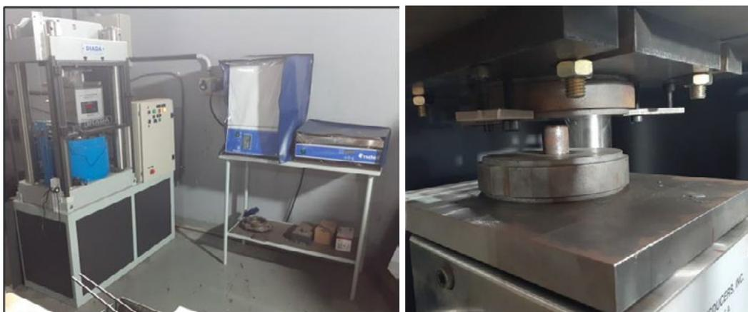
**Figura 1:** Celda de forja (izquierda) y recalado en frío de probeta cilíndrica
