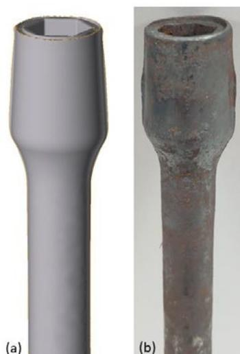
Figura 5 – Forjado final (a) simulado e (b) prático.
