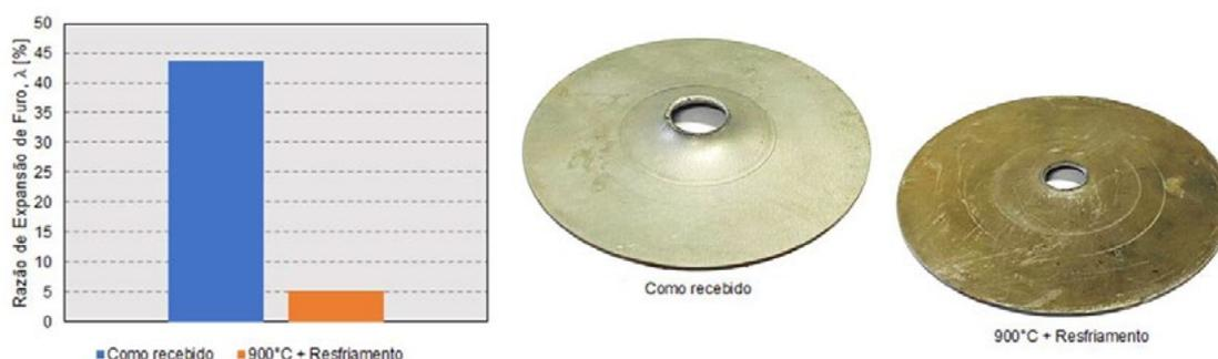
**Figura 7:** Razão de expansão de furo para o aço 22MnB5 como recebido e após aquecimento a 900°C e resfriamento em matrizes resfriadas e amostras após os ensaios de expansão de furo.
