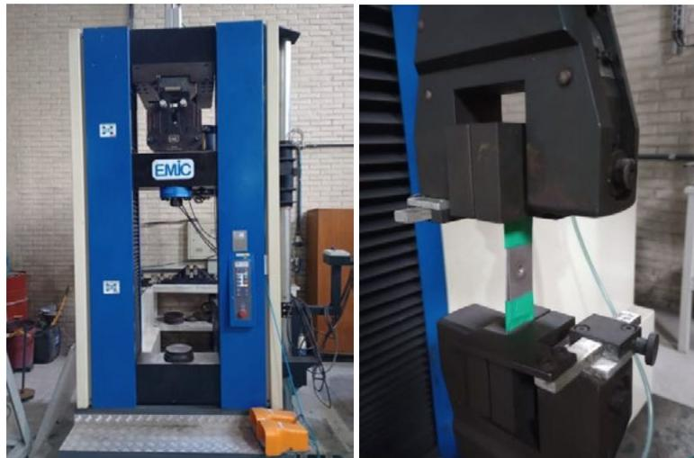
Figura 11 Equipamento utilizado para realização dos ensaios de cisalhamento.
