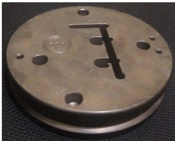
Figura 13 – Matriz fabricada para aplicação no processo de extrusão de um perfil sólido assimétrico.
