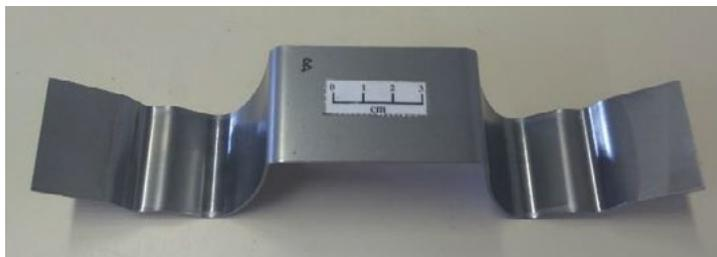
**Figura 5.** Corpos de prova utilizados nos ensaios físicos de estampagem.
