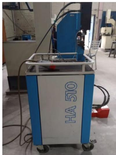
Figura 7 Equipamento utilizado para realização dos ensaios de *clinch*ing.
