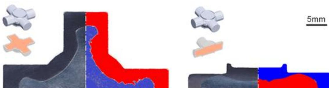
Figura 5 – Comparação entre o fluxo de material experimental e da simulação numérica.
