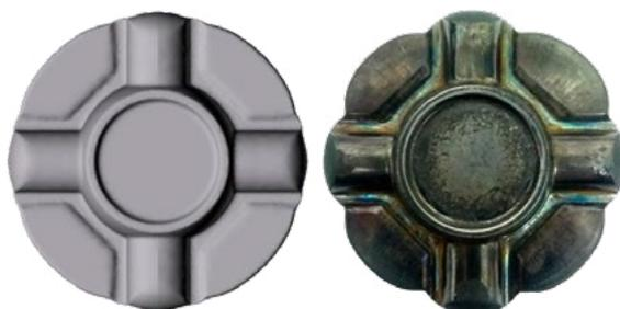
**Figura 10.** Cruzeta simulada pelo software Qform cruzeta e forjada, respectivamente
