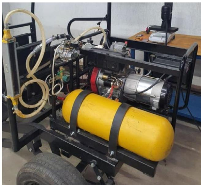
Figura 1: Conjunto motor-gerador e reservatório de biometano montados no veículo elétrico híbrido Agrovec.
