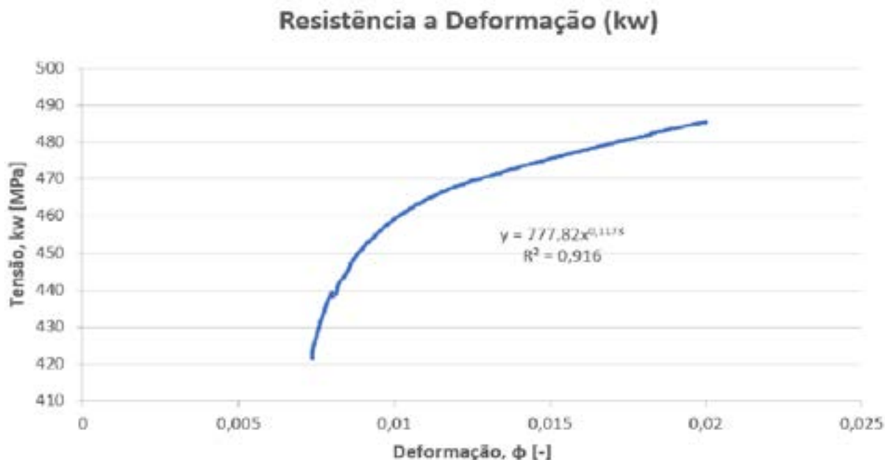
Figura 4: Curva de Resistência a Deformação ( k_w )
