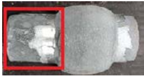
Figura 5 - Região de fixação para usinagem.
