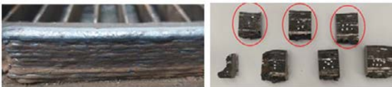
Figura 3: Preparação das amostras para análise de metalografia e dureza. Do autor, 2023.
