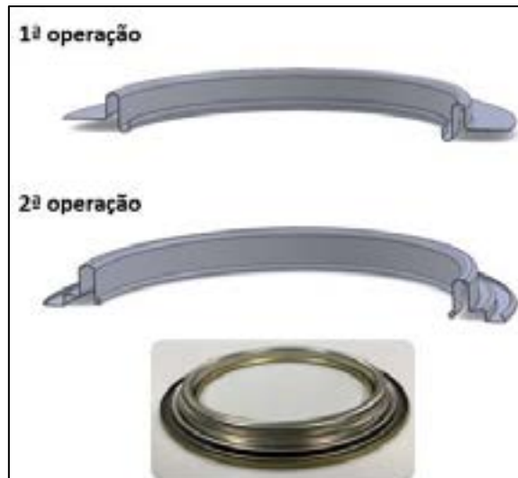
Figura 12 – Produto de estampagem do Anel 04 em duas operações.
