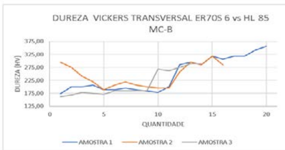
Figura 4: Análise de microdureza Vickers na transversal com material ER70S 6 vs HL 85 MC-B
