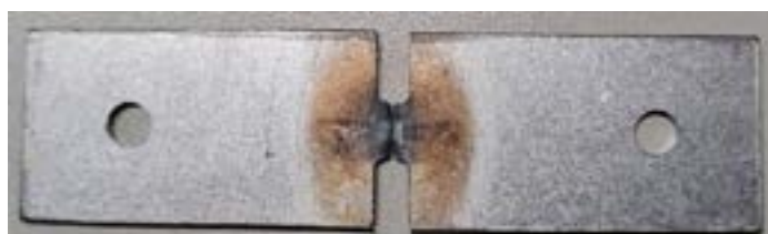
Figura 8. Corpo de prova ensaiado à temperatura de 800°C e 2 s -1 .
