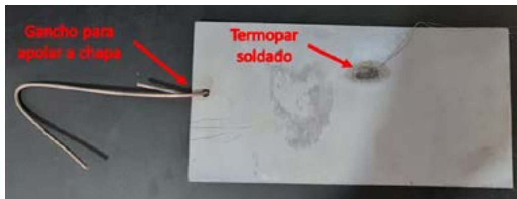
Figura 4. Chapa usada para a obtenção da curva de resfriamento.
