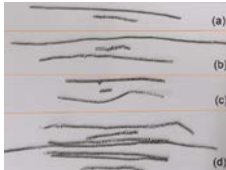
Figura 11 - Cavacos separados conforme processos de usinagem para taxa de resfriamento (a) 0,8 °C/s, (b) 1,0 °C/s, (c) 1,8 °C/s e (d) 2,9 °C/s.
