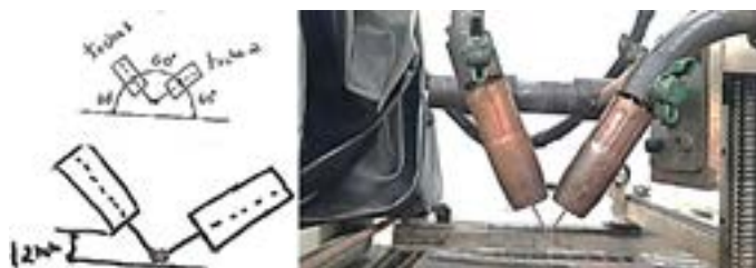
Figura 3: Tochas alinhadas de acordo com o ângulo. Elaborado pelo autor, 2023.
