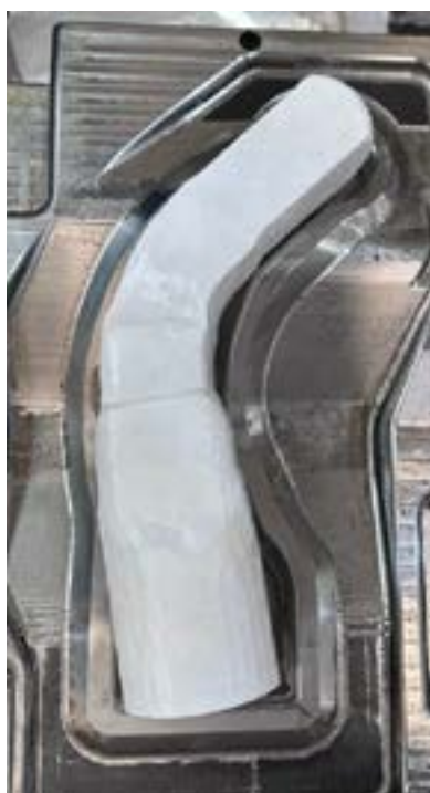
Figura 9 – Demonstração do posicionamento da segunda pré-forma da peça Braço de Direção sobre a matriz inferior do forjamento final.
