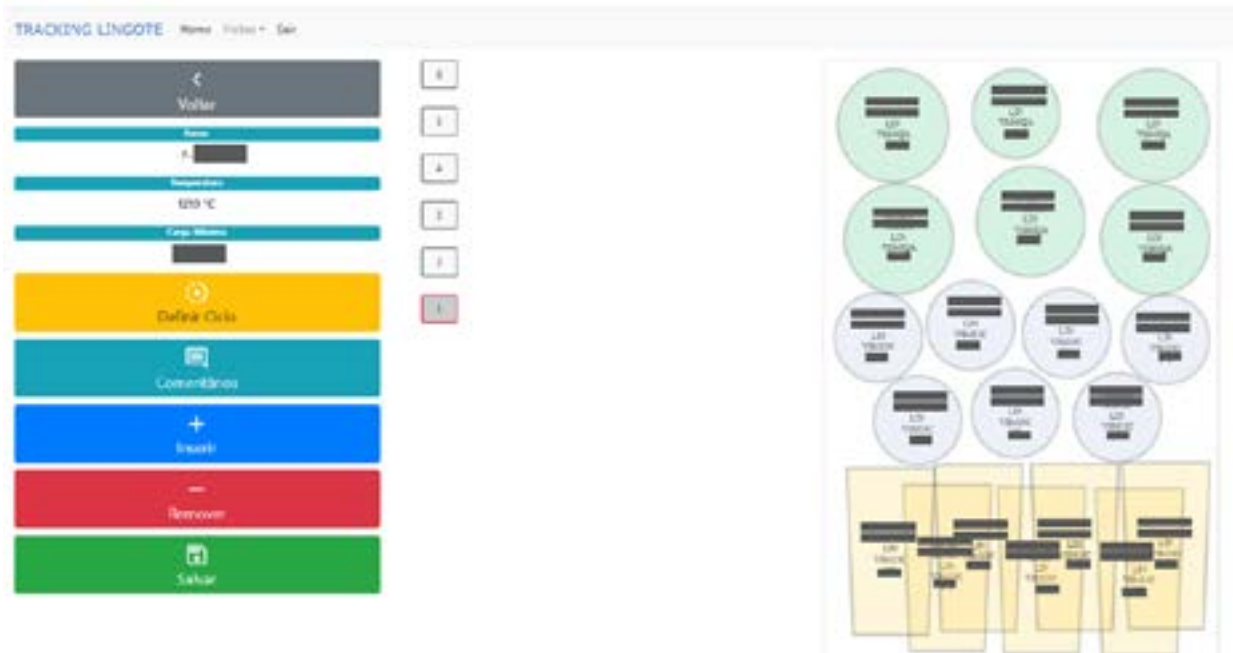
Figura 7: Tela de forno com mapeamento real de lingotes
