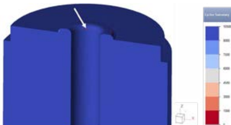
Figura 8 – Indicação da região de início da fratura por fadiga.
