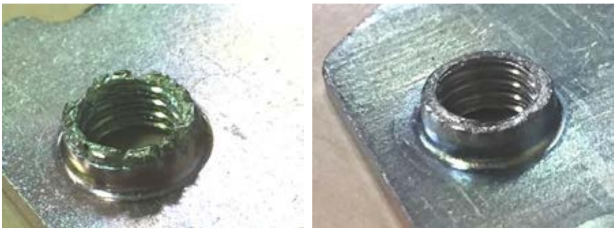
Figura 12: Condição do repuxo da liga 1 (C-Mn) foto à esquerda e liga 2 (Microligado) foto à direita.
