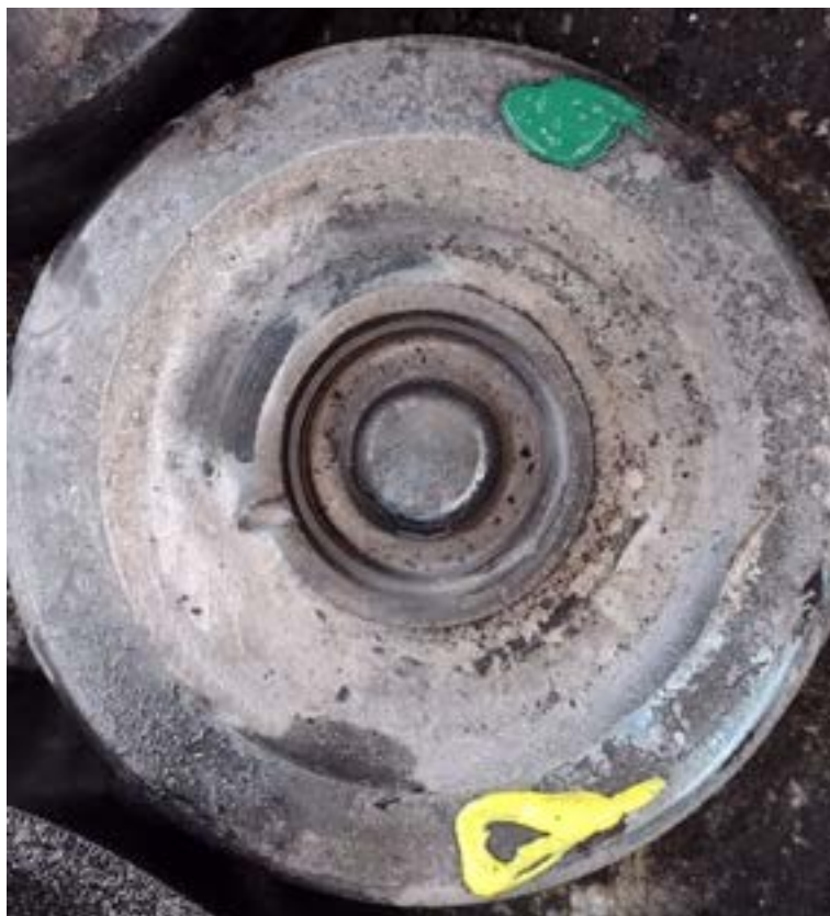
Figura 8 – Fotografia da matriz nova mostrando reduzido desgaste na região da rebarba após produzir 800 peças.
