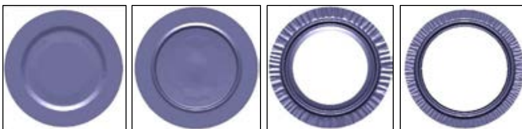
Figura 21 – Evolução da simulação numérica para FFL 0,22 TH415 2,0/2,0.
