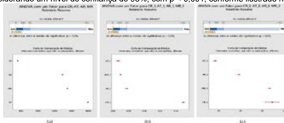
Figura 10: Resultados estatísticos de ANOVA com um fator onde, (a) limite de resistência à tração; (b) alongamento; (c) energia absorvida; (CR) conforme recebido; (AT) austêmpera; (AR) austêmpera revenida; (MR) tempera revenida. Fonte: o autor.
