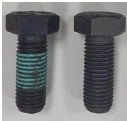
Figura 4: Parafusos avaliados: atual de produção (lado esquerdo) e proposto (lado direito)
