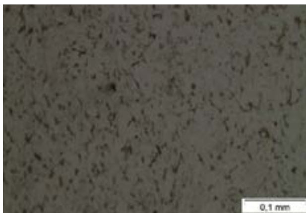
Figura 9: Metalografia dos corpos de provas após manufatura aditiva. Fonte: do autor (2023).
