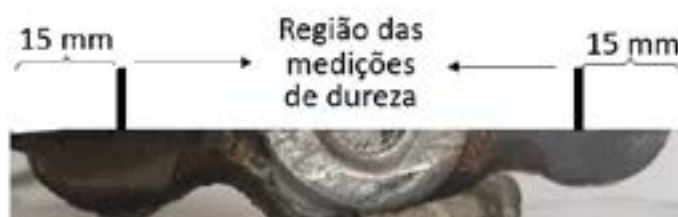
Figura 7: Representação do procedimento utilizado para medições das durezas Fonte: do autor (2023)
