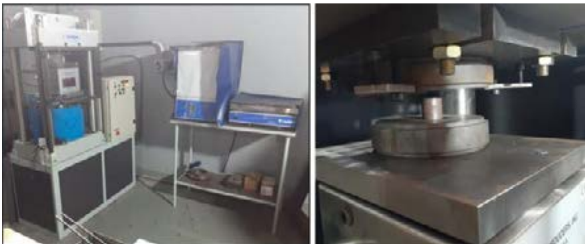
Figura 1 – Celda de forja compuesta por Horno, prensa, placa calefactora y celda de carga
