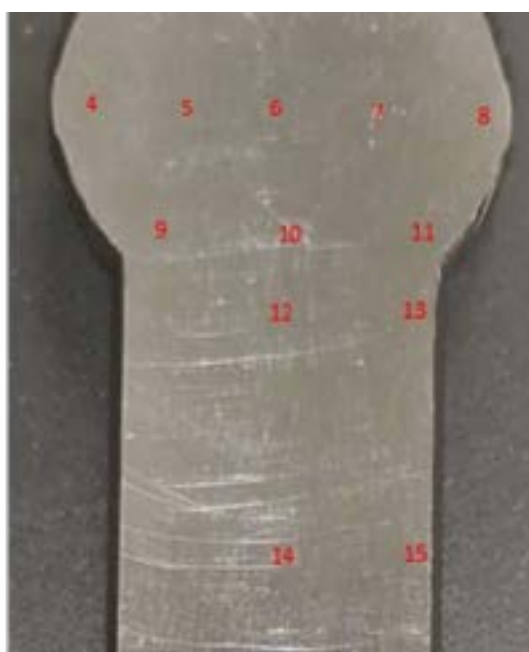
Figura 8 – Durezas medidas na seção longitudinal do forjado.
