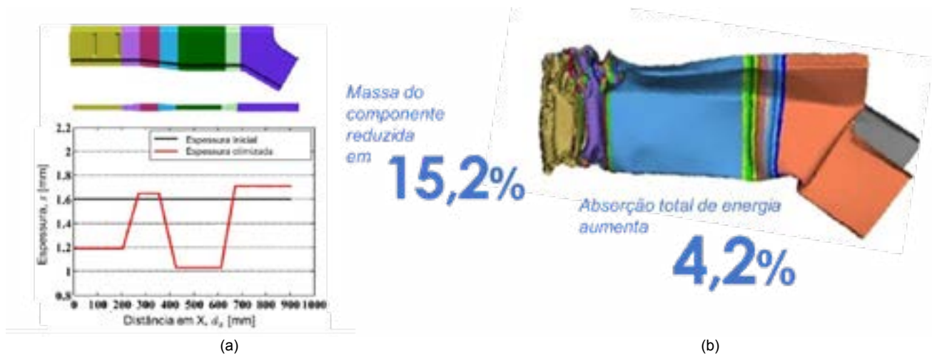
Figura 18: (a) Perfil otimizado de espessura da longarina dianteira. (b) Padrão de deformação do componente com a espessura da estrutura TRB otimizada [9].
