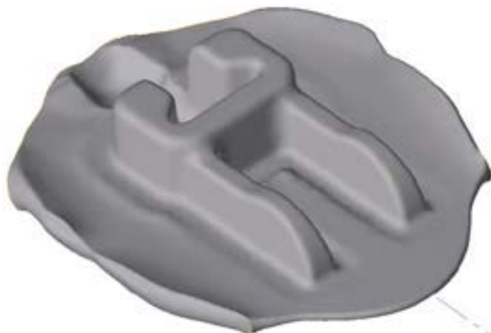
Figura 3 – Peça Concha-Garfo forjada via simulação.
