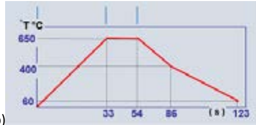
Figura 5 – a) Linha de Recozimento Contínuo na CSN. b) Patamares de Temperatura x Tempo do ciclo térmico [3].
