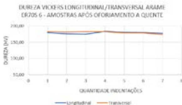
Figura 8: Comportamento Dureza (HV) sentido longitudinal e transversal nas peças impressas e forjadas. Fonte: do autor (2023).
