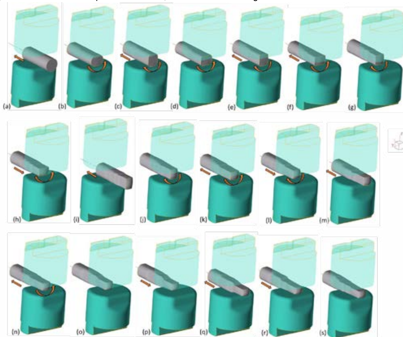
Figura 6 – Simulação da sequência de golpes realizados na conformação da primeira pré-forma da peça Braço de Direção.
