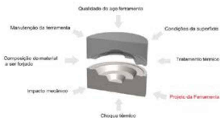
Figure 1: Parâmetros que afetam a vida de uma ferramenta [10].
