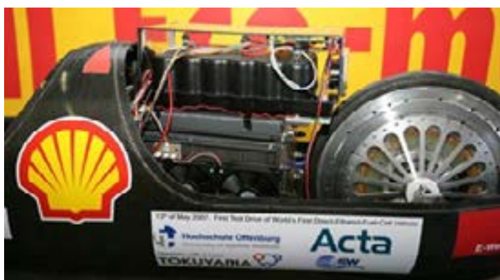
Figure 4: Protótipo do primeiro teste com uma célula direta a etanol [12].
