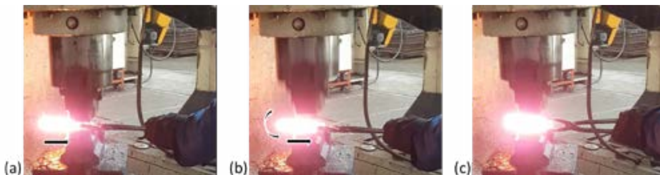
Figura 1 – Sequência do forjamento de uma pré-forma usando martelete.
