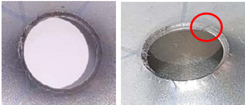
Figura 6: Amostras depois do ensaio de expansão de furo e região amostrada (Fonte: o Autor).
