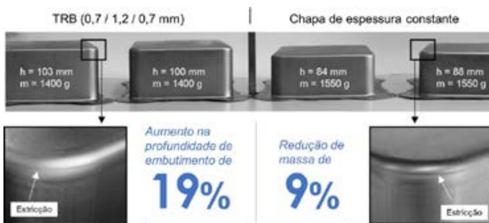
Figura 10: Comparação de um copo de 82 mm de profundidade feito de TRB e de uma chapa de espessura constante de 1,2 mm [10].
