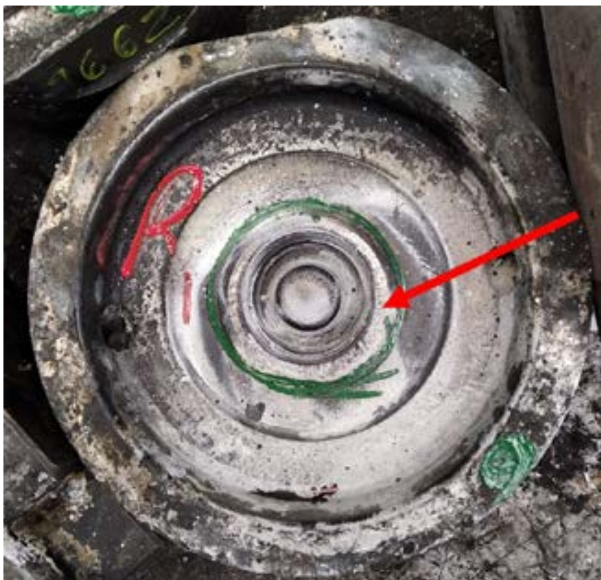
Figura 2 – Fotografia da matriz antiga mostrando intenso desgaste na região da rebarba (seta vermelha) após produzir 800 peças.
