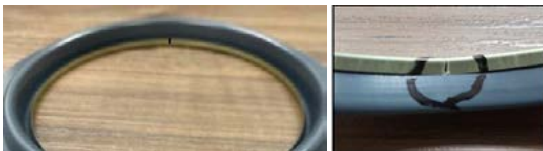
Figura 23 – Falha ocorrida no Anel 04 (1ª operação). Material FFL 0,22 TH415 2,0/2,0.
