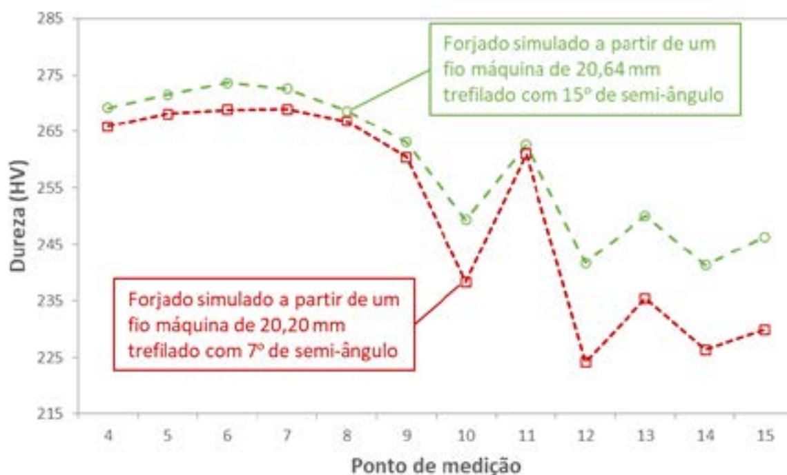
Figura 18 – Previsão da distribuição da dureza no forjado a partir de dois tarugos com resistências mecânicas distintas.
