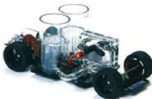
Figure 1: Módulo didático comercial H-TEC com uma célula a combustível reversível e eletrolisador [4].
