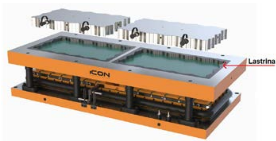
Figura 1: Estampo penetrante completo [18].
