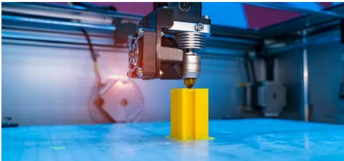
Figura 3: Impressão 3D por processo FDM [13]
