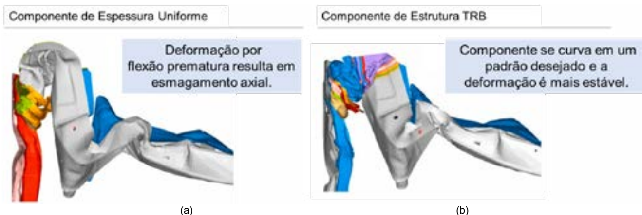
Figura 20: Modelo dos componentes frontal com estrutura (a) de espessura uniforme e (b) TRB.
