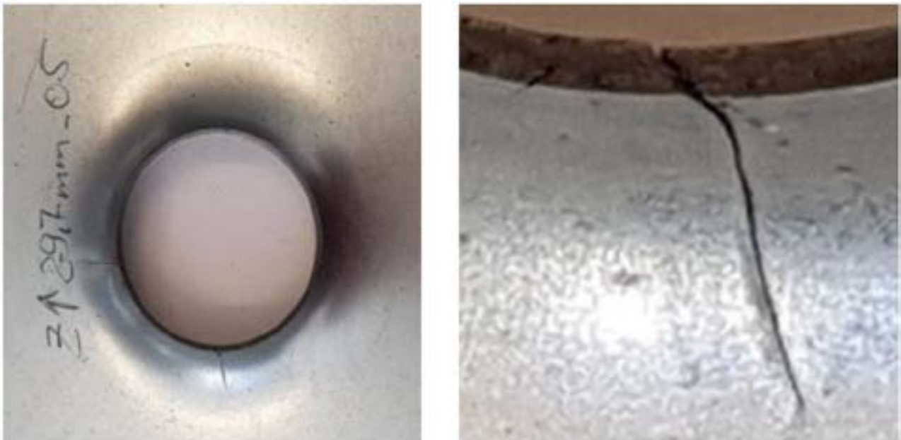
Figura 3: Uma fratura relacionada à insuficiente conformabilidade local. Note a falta de afinamento próximo à fratura [4].
