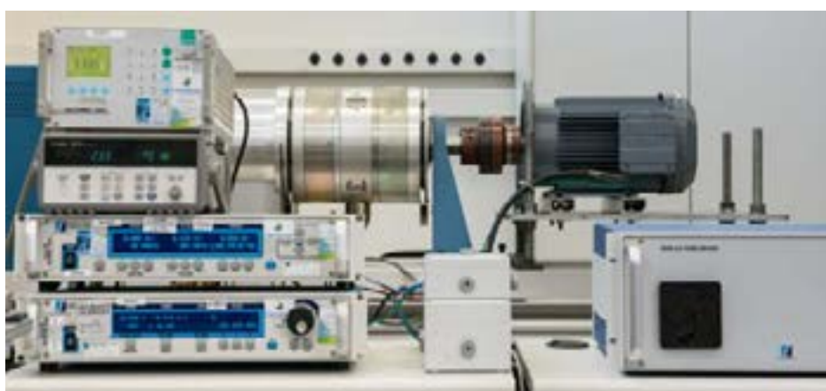
Figura 9: Setup para realização de ensaio de máquina elétrica no LABELO [21].
