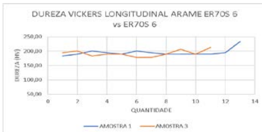
Figura 5: Dureza Vickers para as amostras do arame ER70S 6 vs ER70S 6 em sentido longitudinal. Do autor, 2023.
