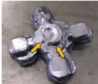
Figura 5: Amostra (01) com imperfeições no encaixe
