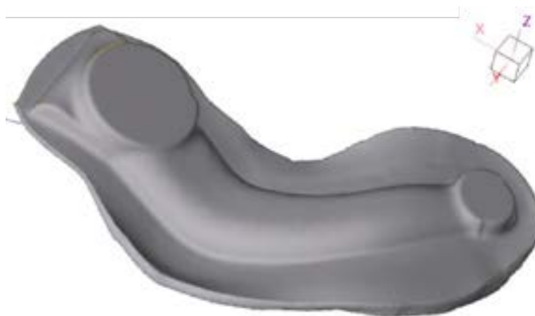
Figura 10 – Braço de Direção forjado via simulação.
