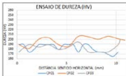
Figura 8: Comportamento Dureza (HV) sentido horizontal. Fonte: do autor (2023).
