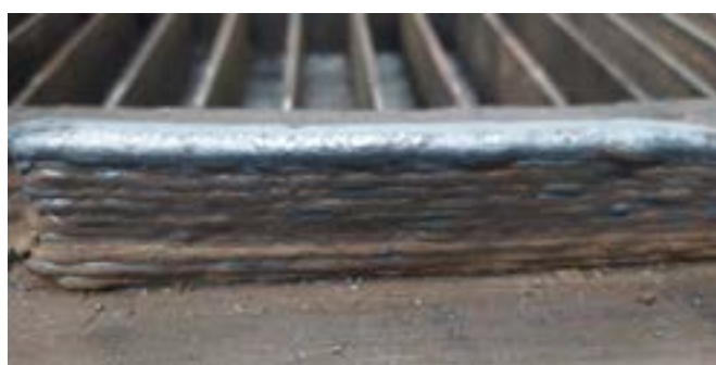
Figura 6: Parede em camadas proveniente da deposição. Elaborado pelo autor, 2023.
