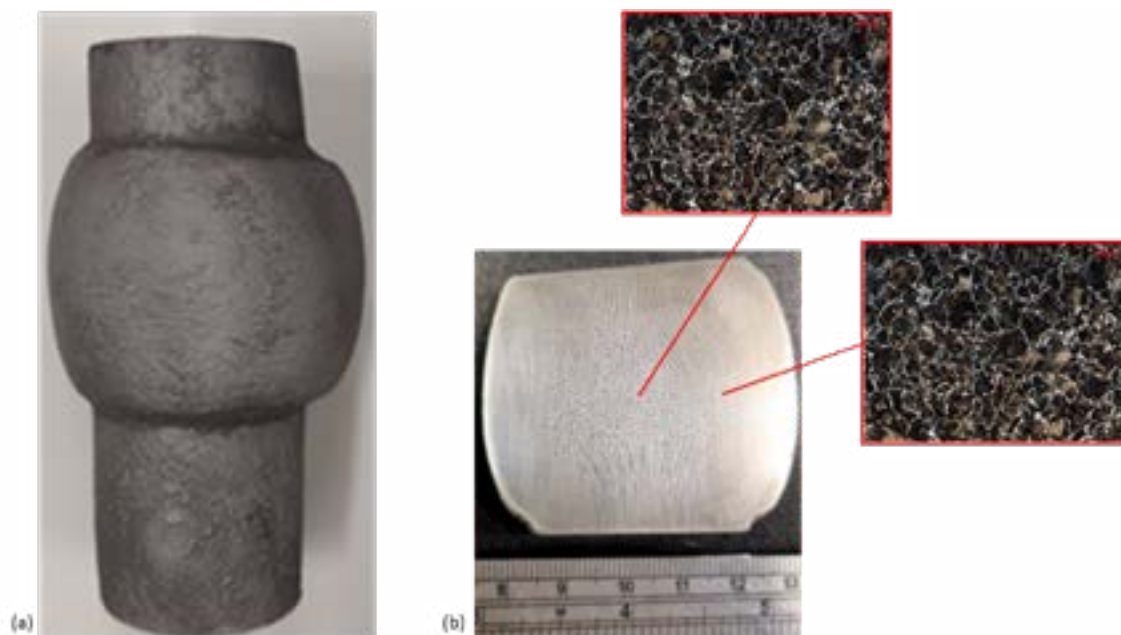
Figura 4 – (a) Peça forjada e (b) sua respectiva micrografia no centro e a meio raio.
