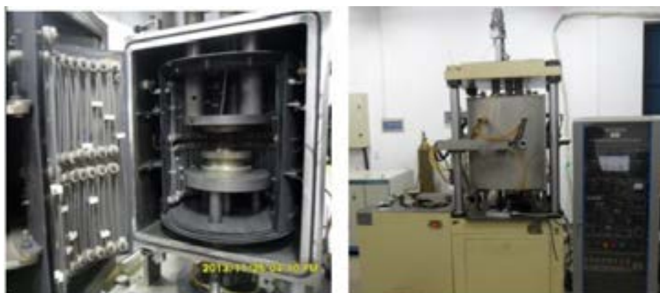
Figura 2. Sistema de ensaio Nakajima à quente (limitado a 400°C). [2]
