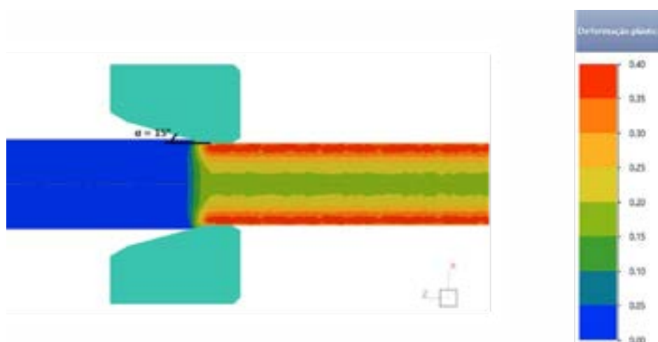
Figura 2 – Previsão da deformação plástica na barra trefilada (seção longitudinal).
