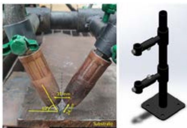
Figura 3: Dispositivo de fixação das tochas. Fonte: do autor (2023).
