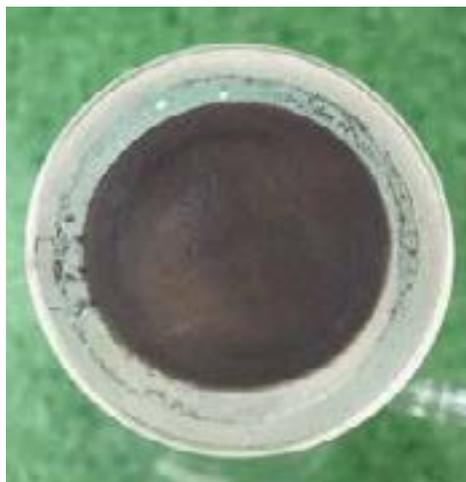
**Figura 2:** Óxido de grafeno depositado sob membrana Celgard 2400.
