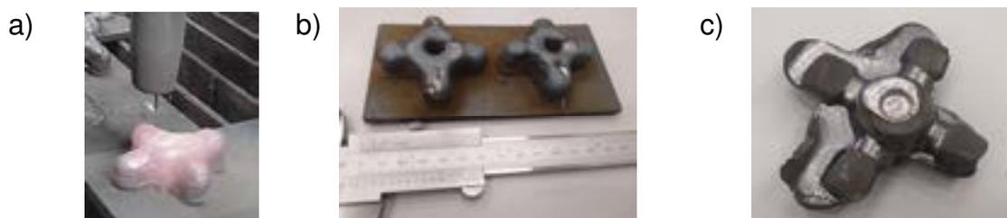
Figura 3: a) Parte externa da cruzeta na máquina de solda; b) amostras impressas; c) cruzeta bimetalica forjada
