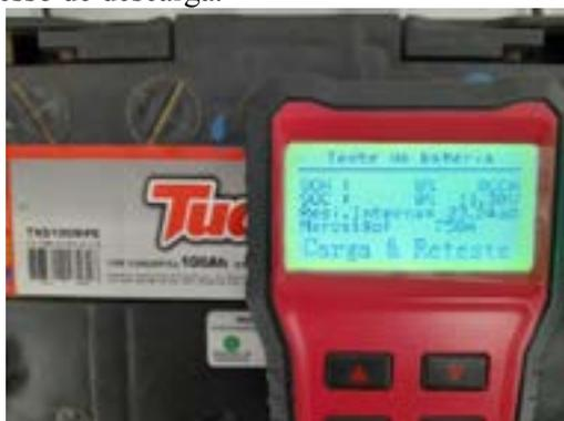
Fig. 08. Teste após a descarga da bateria até 10,5 V.
