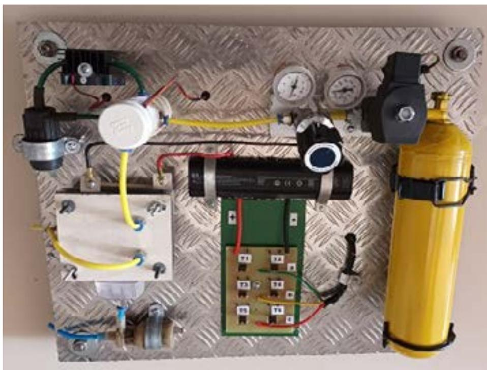
Figura 10: Implementação do kit *FCE* – Fuel Cell Electric
