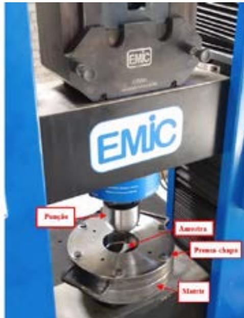
Figura 10 – Representação do ensaio Nakazima modificado executado na EMIC.
