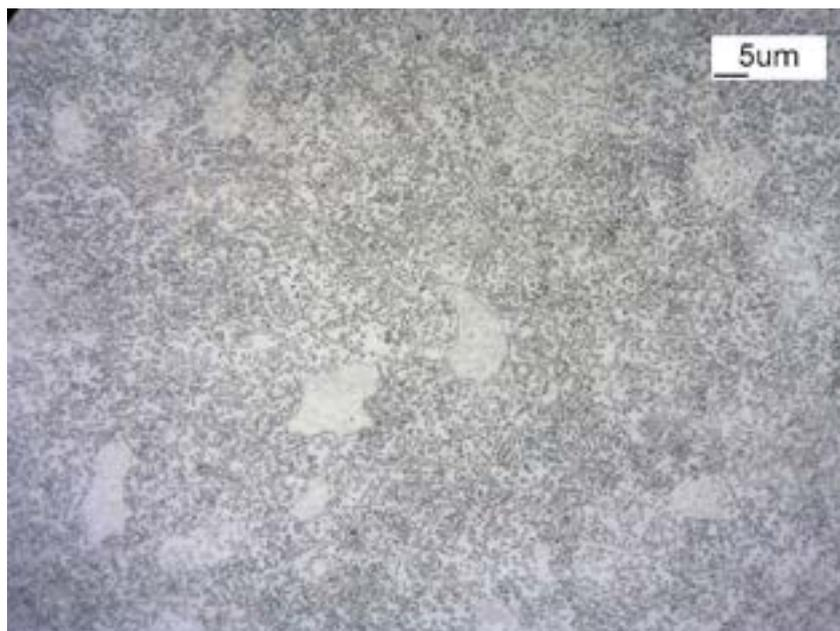
**Figura 5.1.** Microestrutura do aço ASTM 52100, matriz ferrítica (porção clara) e carbonetos esferoidizados (porção escura).
