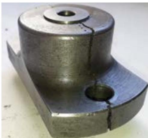
Figura 4: Carcaça de matriz (fraturada) utilizada no processo de forjamento a frio de fixadores, adaptado [10]
