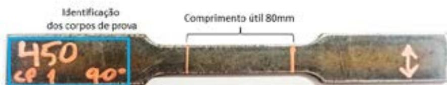
Figura 3 – Identificação dos corpos de prova de tração.
