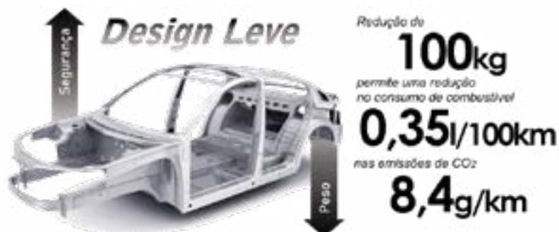
Figura 4 - Tendência atual da indústria automotiva: otimização de resistência ao impacto e peso dos componentes [3].
