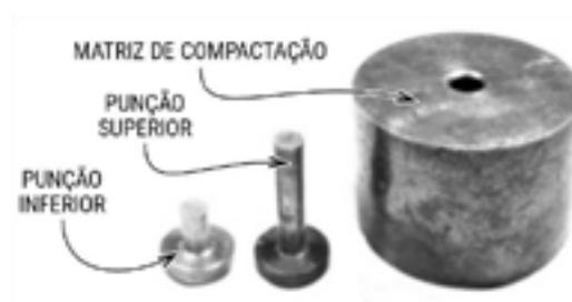
**Figura 4:** Componentes da matriz para compactação das amostras
