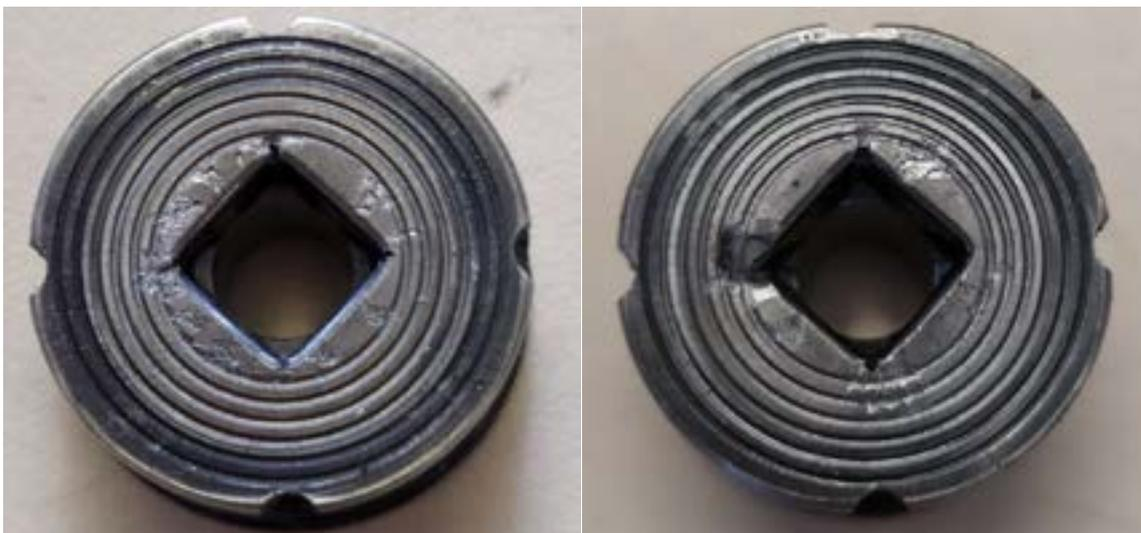
Figura 10 – Aspecto da falha em duas matrizes com nitretação a plasma.
