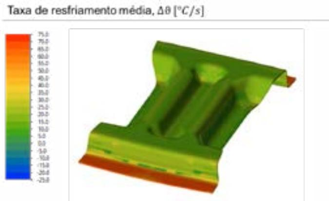
**Figura 15** Taxa de resfriamento média da peça durante a conformação.
