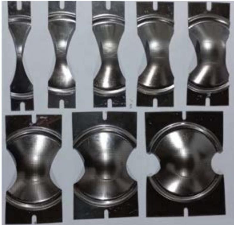
Figura 12 – Representação das amostras após o ensaio Nakazima modificado.
