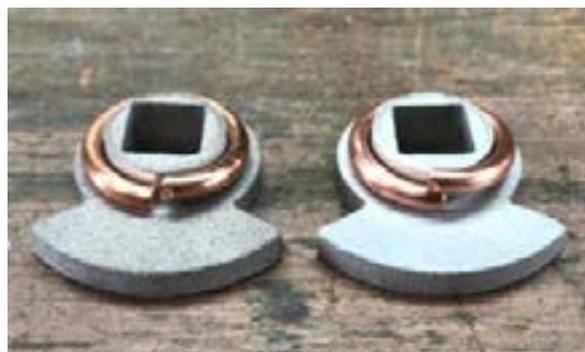
**Figura 2:** Peças de aço com cobre antes da sinterização.
