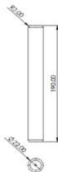
Figura 2. Dimensões, em milímetros, da cavilha (amostra) obtido por fundição.
