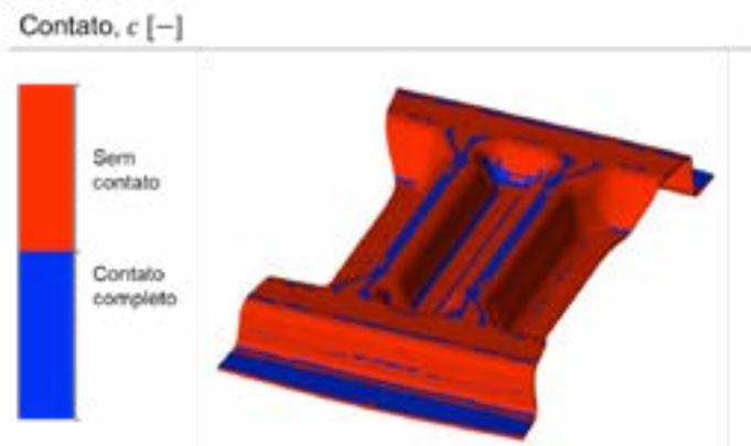
**Figura 16** Contato entre as ferramentas e a peça durante a conformação.
