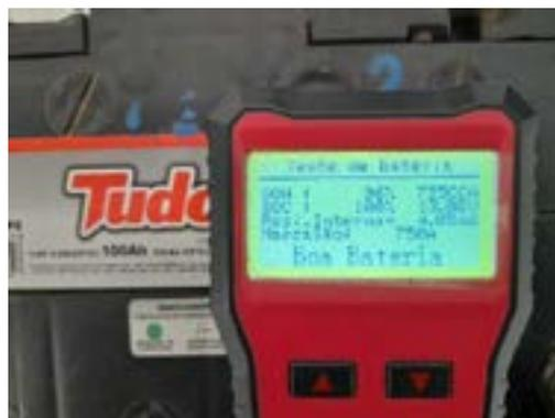
Fig. 09. Teste após a última carga com aplicação da tensão de equalização máxima que a bateria admitiu.
