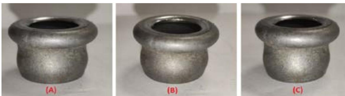
Figura 3: Corpos de provas após o ensaio de compressão.
