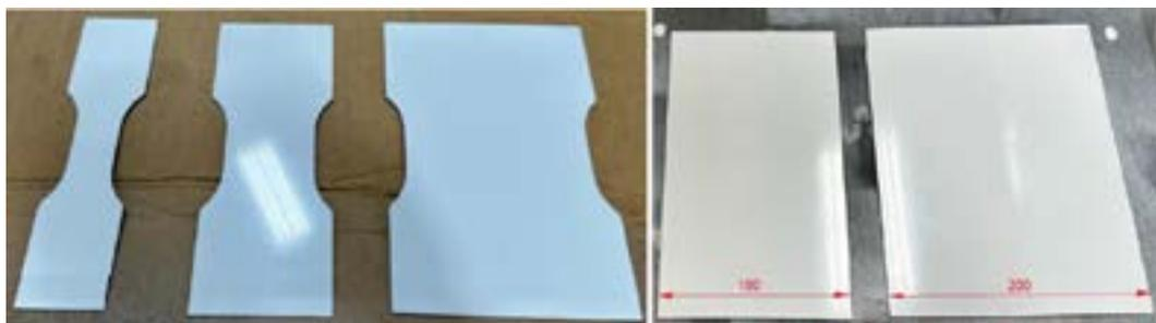
**Figura 3:** Geometria dos corpos de prova Nakajima.
