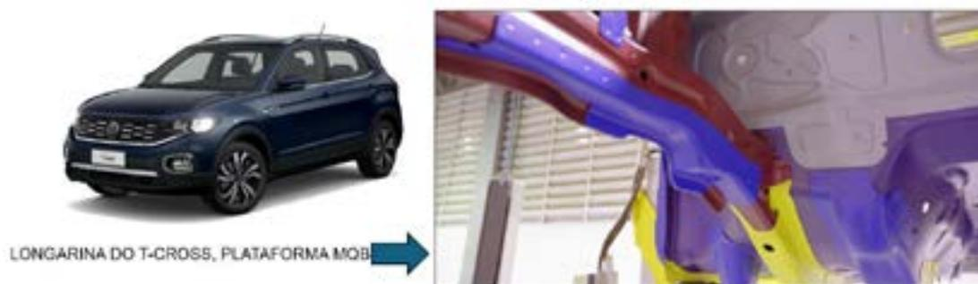
Figura 3 - Representação dos diferentes materiais que compõem a longarina de um veículo modelo T-Cross.
