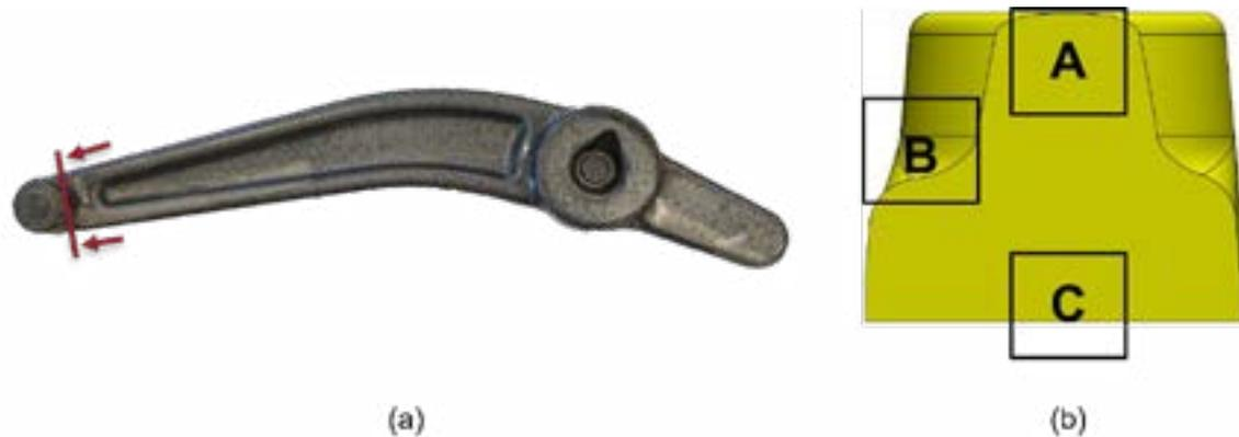
Figura 14. Análise da microestrutura: (a) Plano de corte da secção em análise; (b) Zonas a serem analisadas na secção cortada.
