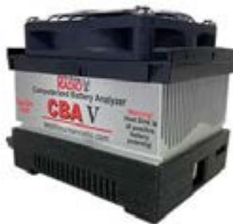
Fig. 03. Analisador de Bateria Computadorizado (Computerized Battery Analyzer – CBA).
