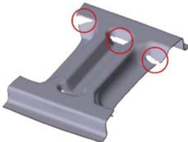
Figura 24 – Locais de ruptura da peça final durante a simulação computacional.
