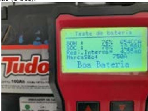
Fig. 06. Teste após retirada de operação da bateria.
