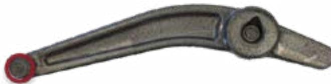
Figura 10. Zona para a medição de dureza na peça.
