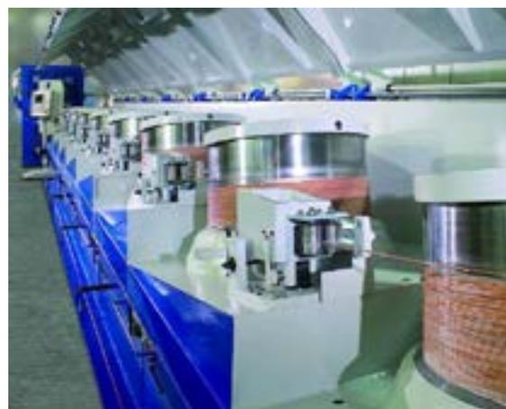
**Figura 1** – Processo de trefilação multipasses [7]. **Figura 2** – Fotografia do processo de trefilação [8].
