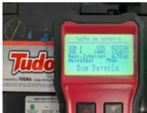
Fig. 07. Teste após carga convencional da bateria.
