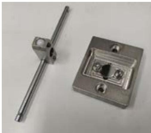
**Figura 4.5.** Suporte da esfera (a esquerda) e porta-amostra do disco com recipiente para ensaio com lubrificante (a direita).
