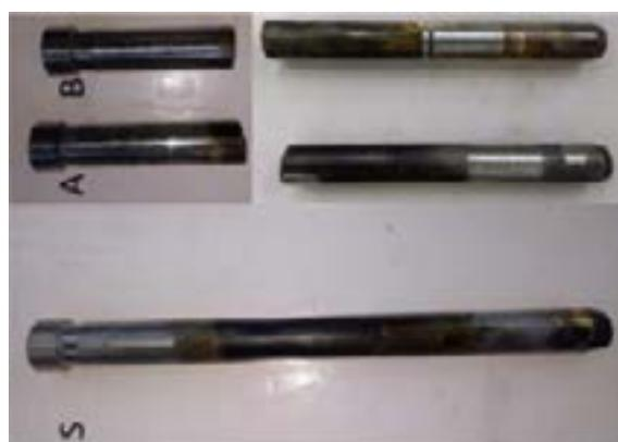
Fig. 2: Mandriles fracturados
