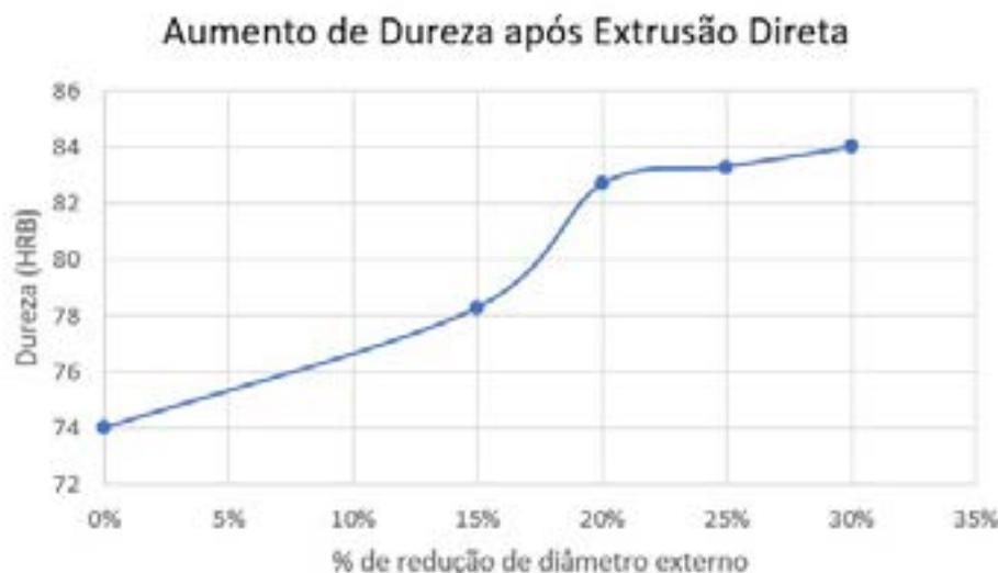
Figura 12: Aumento de Dureza após extrusão.
