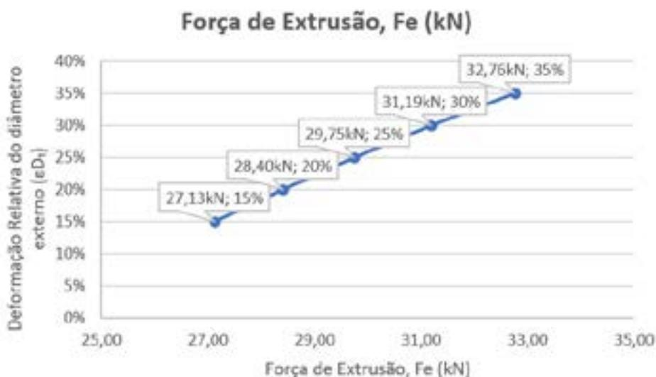
Figura 11: Força de Extrusão,  $F_e$  (kN)
