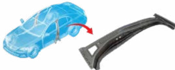
**Figura 1** Coluna B de um veículo [8].
