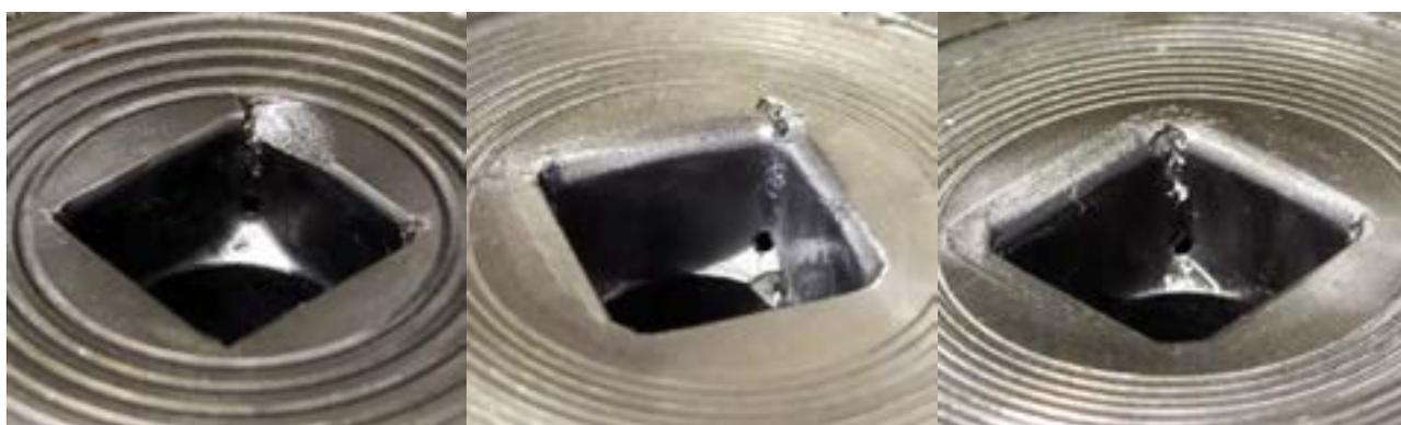
Figura 7 – Aspecto da falha em diferentes matrizes de mesmo material, utilizadas no mesmo processo.
