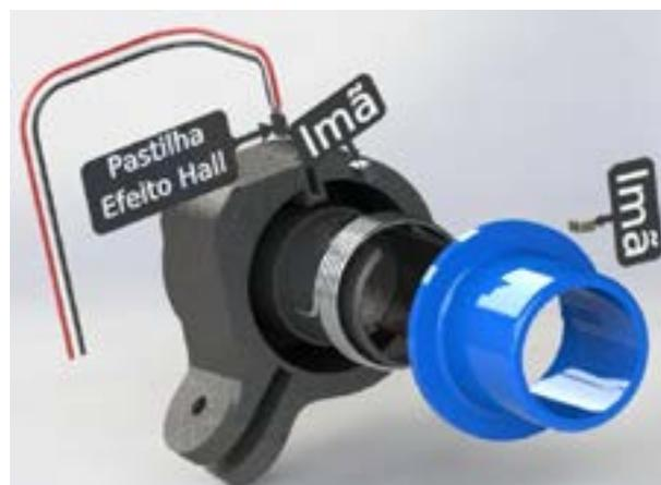
(b) Desenho CAD de um acelerador de ciclomotor
