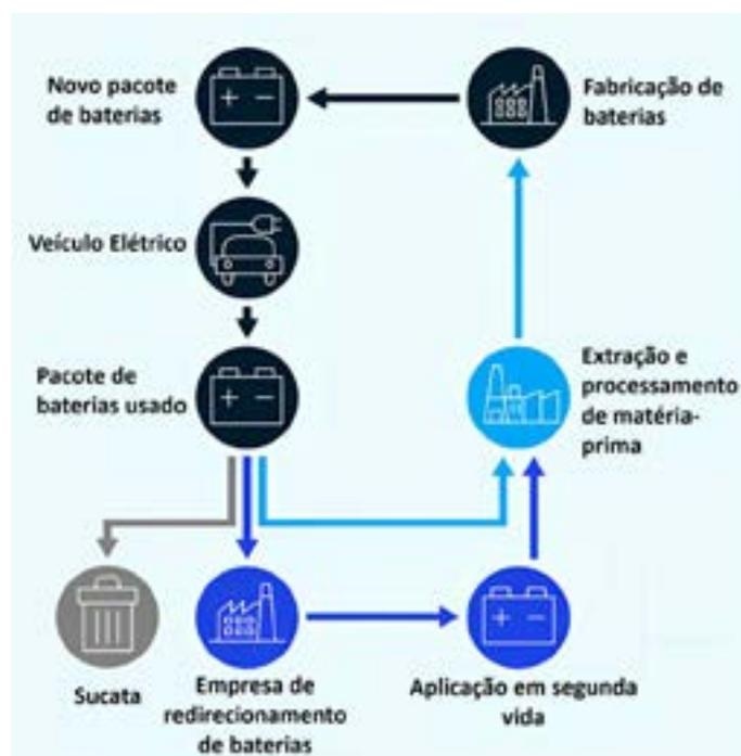
**Figura 2:** Bloco de diagramas das fases da bateria (aplicações e monitoramento). Adaptado de [4]
