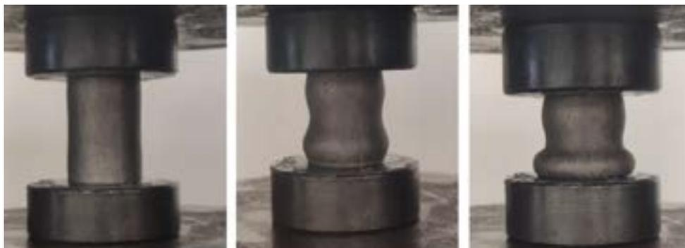
Figura 2: Ensaio de compressão em diferentes estágios
