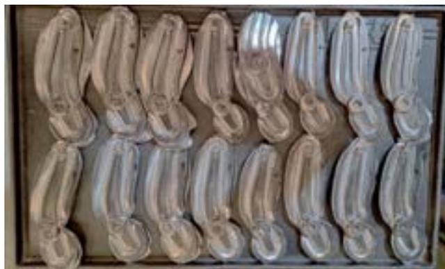
Figura 8. Peças após o processo de forjamento.
