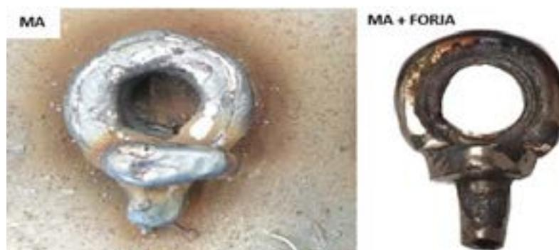
**Figura 4:** Olhal fabricado por manufatura aditiva (MA), olhal fabricado pelo processo híbrido (MA + Forja).
