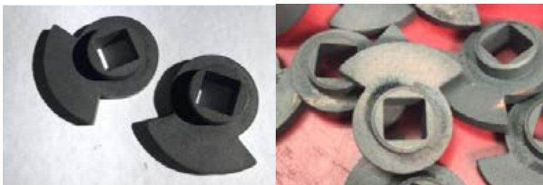
**Figura 3:** Peças de aço sinterizado antes e depois da oxidação negra e infiltração de cobre.
