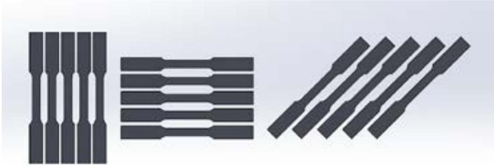
**Figura 3:** Ilustração das posições dos corpos de provas.
